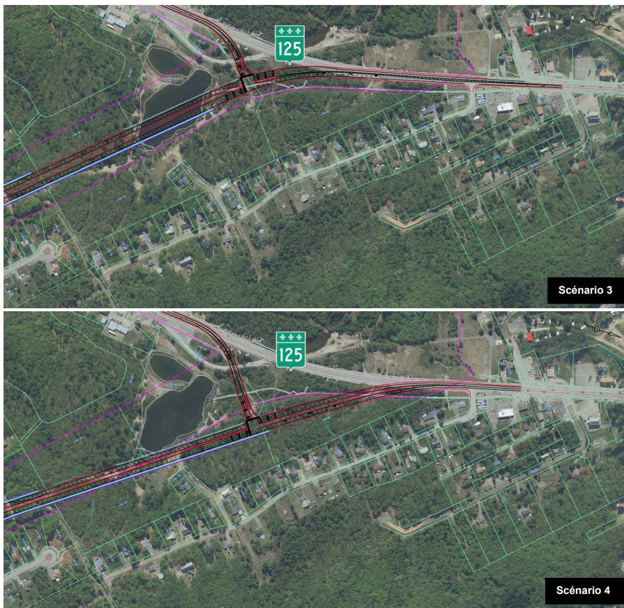
Figure 3-7 Scénarios de raccordement du contournement à la R-125 au nord de Sainte-Julienne (concepts préliminaires)
