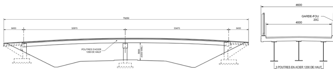
Figure 3-21 Pont à poutres à âme pleine en acier
