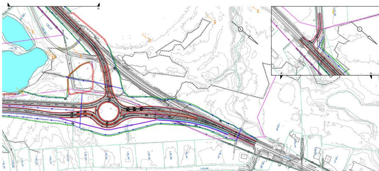
Figure 3-13 Extrait géométrie – carrefour giratoire (scénario 5)
