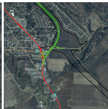
2B - Limitant les acquisitions, géré par des intersections avec feux de circulation
