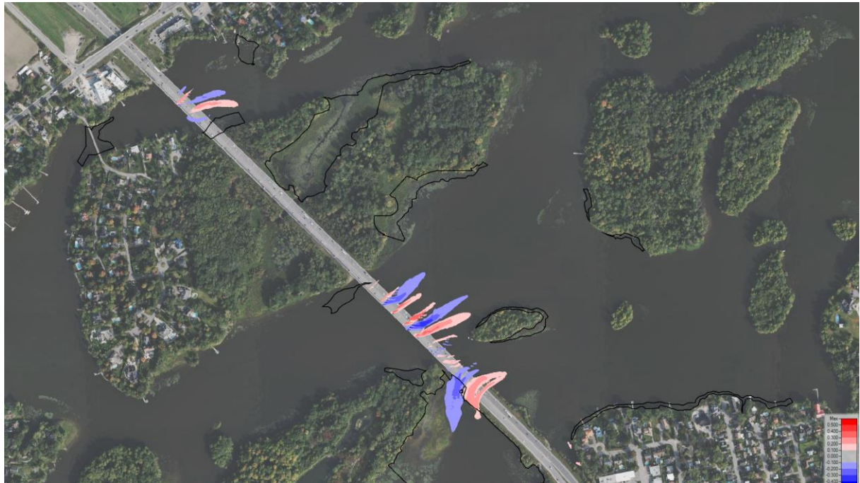
Figure 5.9 : Différentiel de vitesse au débit moyen annuel et frayères : pont projeté (effet des piles)
