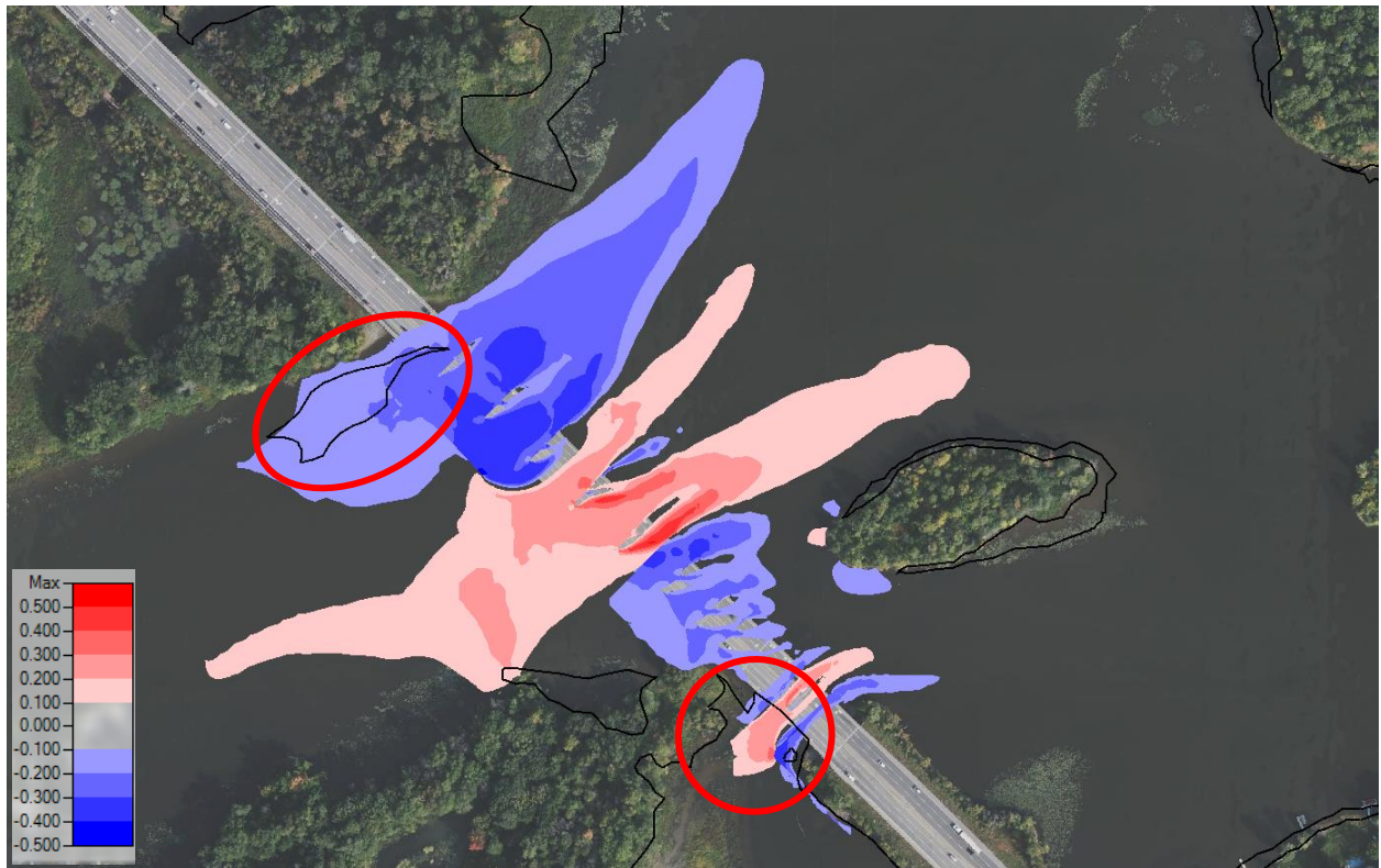
Figure 4.6 : Différentiel de vitesse au débit moyen annuel et frayères : conditions temporaires de phase 2 Scénario 8 comparé à 2. Les zones grisées représentent les zones de frayère.
