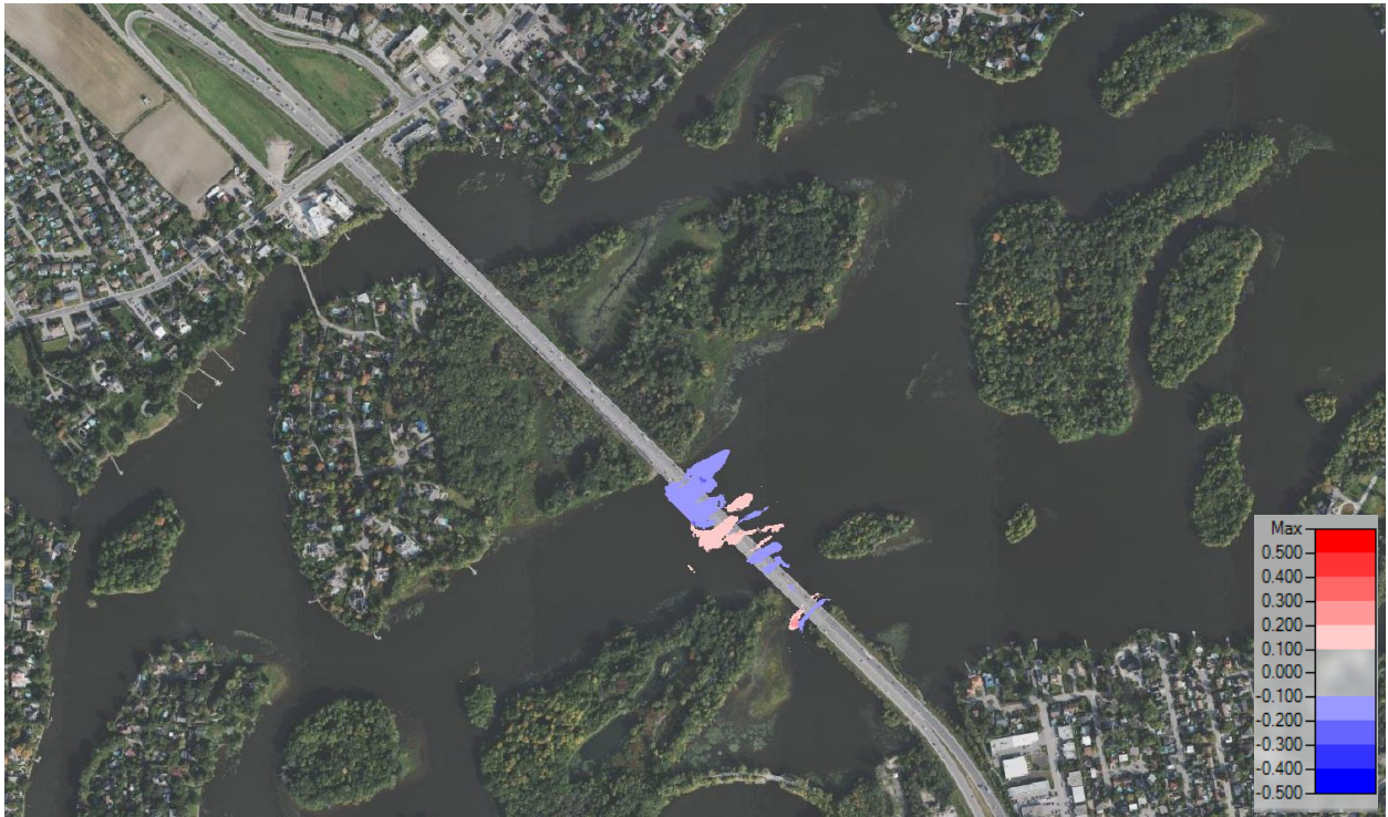
Figure 4.2 : Différentiel de vitesse au débit d'étiage pendant la phase 2 des travaux Scénario 7 comparé à 1
