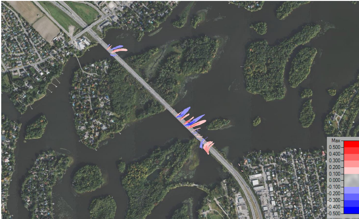
Figure 5.5 : Différentiel de vitesse au débit moyen annuel : pont projeté Scénario 17 comparé à 2
