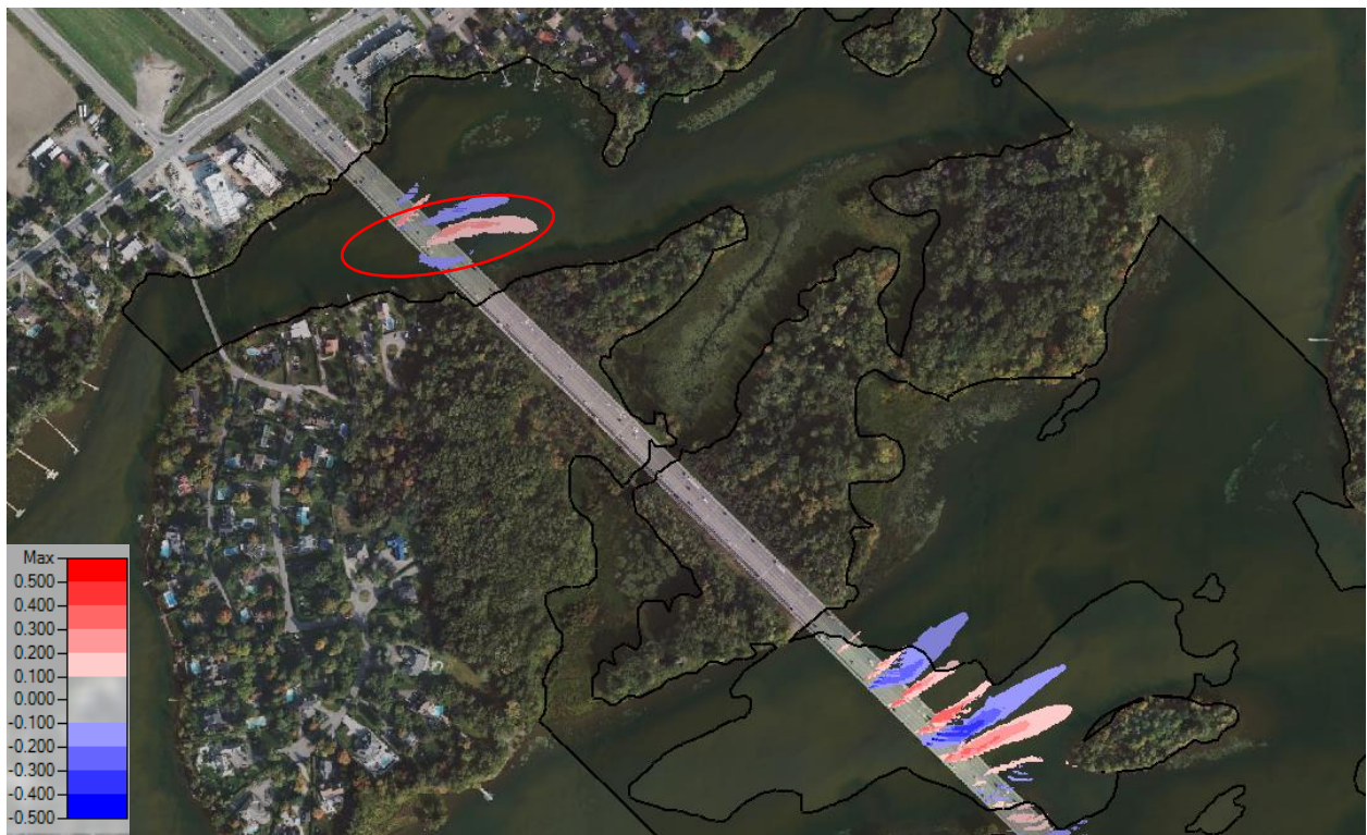
Figure 5.7 : Différentiel de vitesse au débit moyen annuel et zones de substrat fin : pont projeté (effet des piles)
