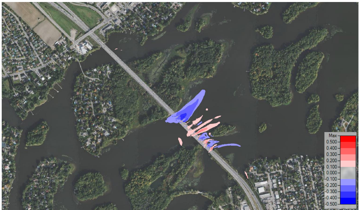
Figure 3.3 : Différentiel de vitesse au débit moyen annuel : conditions temporaires de phase 1 Scénario 5 comparé à 2
