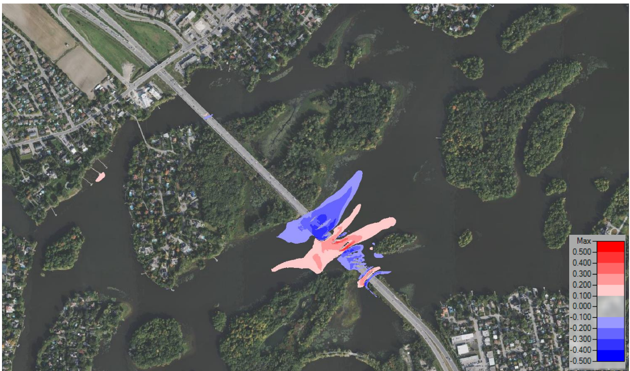
Figure 4.3 : Différentiel de vitesse au débit moyen annuel pendant la phase 2 des travaux Scénario 8 comparé à 2
