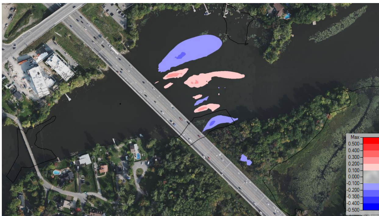
Figure 3.7 : Différentiel de vitesse en crue 2 ans et frayères : conditions temporaires de phase 1 (chenal nord)
