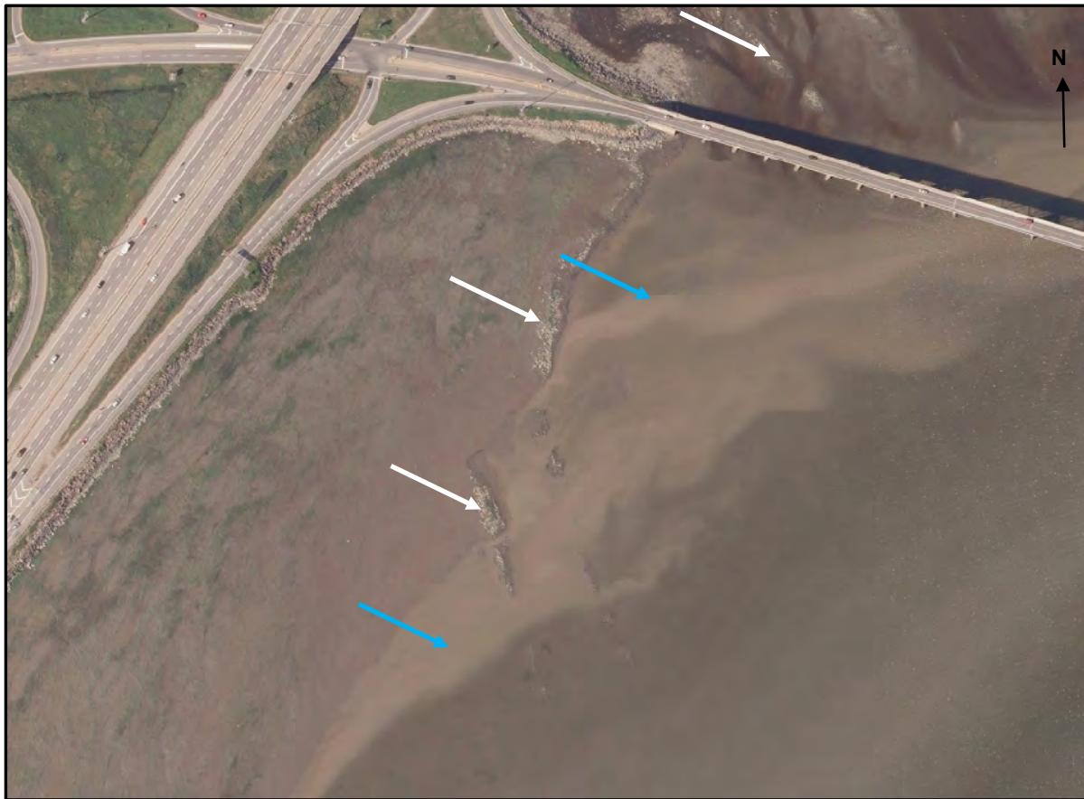
Figure 6 Cordons de blocs glaciels (indiqués par les flèches blanches) formés par le transport de matériaux grossiers par des radeaux de glaces flottantes et concentration de sédiments en suspension provenant de l'érosion de la slikke à marée basse (flèches bleues)
