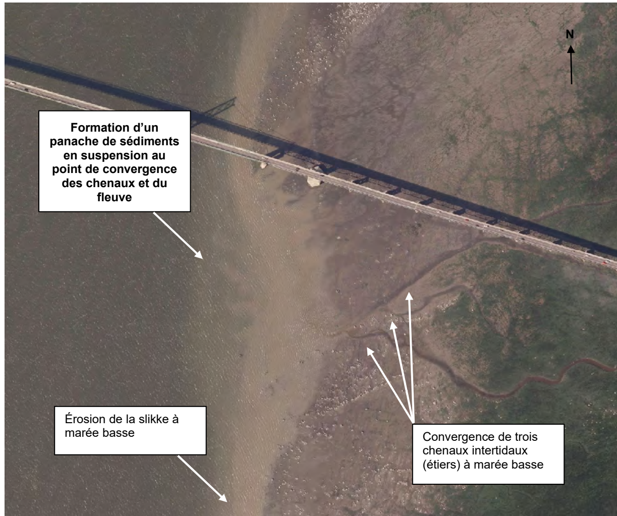
Figure 7 Convergence de trois chenaux intertidaux où les sédiments érodés forment un panache dans les eaux du fleuve.
