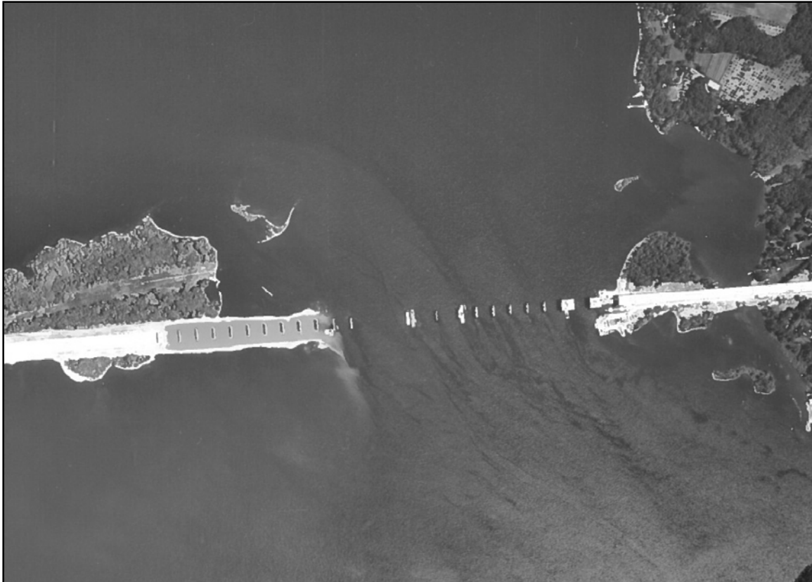
Figure 12 : Extrait de photographie aérienne de 1964 montrant les estacades et les remblais aménagés pour la construction du pont de l'Île-aux-Tourtes. (Photographie Q64511-150)
