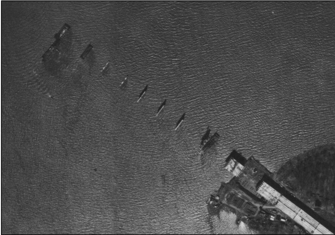
Figure 14 : Extrait de la photographie aérienne de 1965 montrant le remblai aménagé sur l'île Girwood et les caissons pour la construction des piles (archives de la ville de Montréal VM97-05-262).
