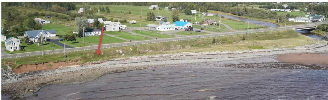
Figure 5-2 Photographie oblique de 2021. Dommages à l'ouest du ponceau (flèche rouge). Talus qui n'a pas montré de modifications entre 2010 et 2021 à l'est du ponceau. La plage commence à s'éloigner de la route à partir du ponceau. Source : LDGIZC
