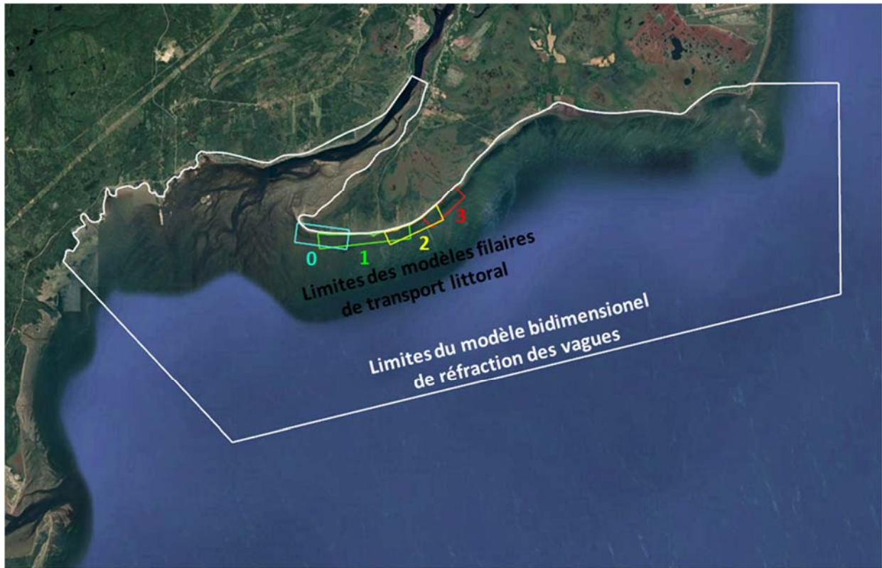
Figure 6.10 : Limites des divers modèles filaires de transport littoral (LITPACK)
