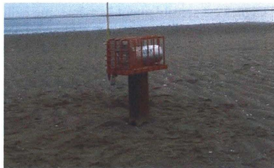
Figure 36 : Capteur de pression installé à l'été 2001 sur l'estran de la péninsule de Manicouagan Tiré de Karakiewicz et al. , 2001
