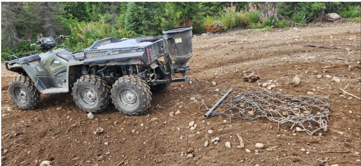
Photo 7 Véhicule tout-terrain avec épandeur et herse (ensemencement à la volée)
