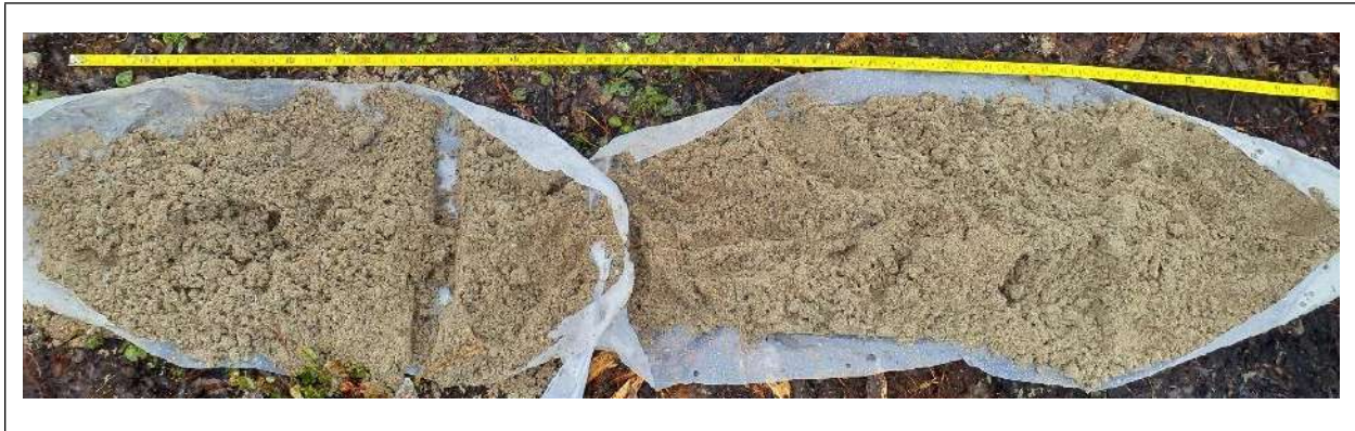
Figure 4-3 Dépôt pulvérulent fin– Échantillon CS-04 du forage 24F-01
