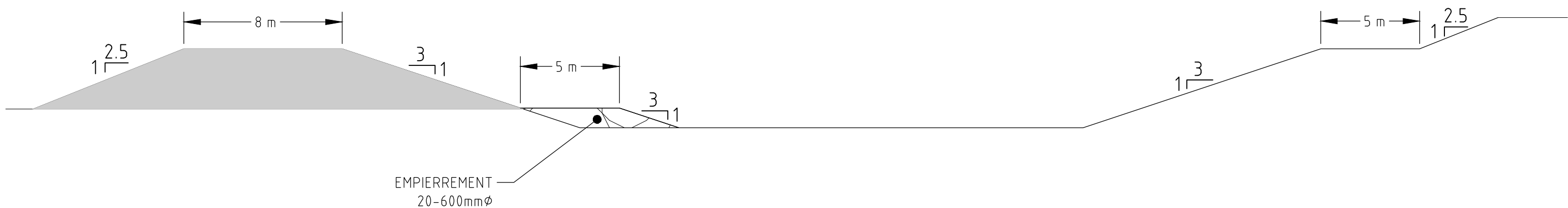
DÉTAIL DES BERMES BASSIN PAR 2 PROPOSÉ Échelle 1:200
