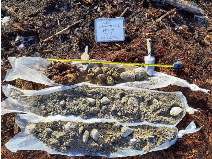
PHOTO 5 Forage 24F-5 sur Gravtest-4, profondeur entre 0 m et 2,74 m. Matériel non conforme entre 1,80 m et 2,74 m.
