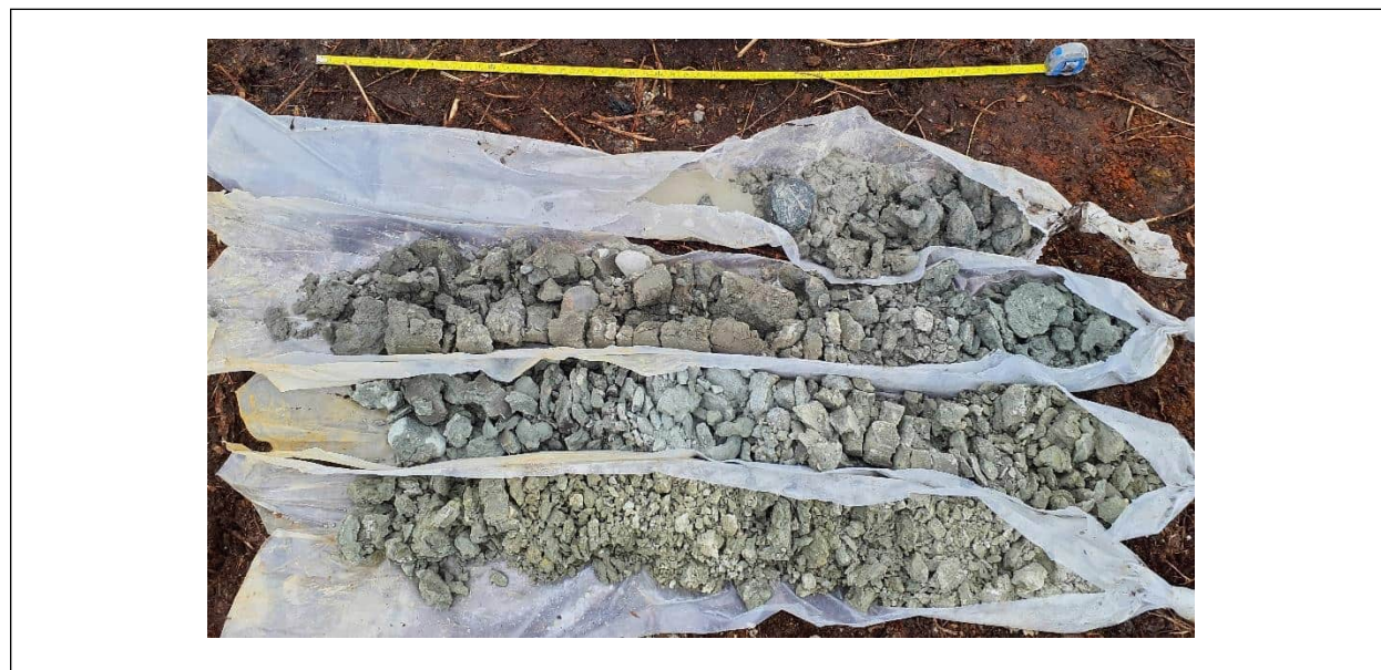
Figure 4-4 Dépôt pulvérulent fin – Échantillon CS-06 du forage 24F-05
