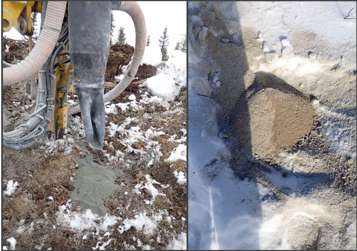
Figure 7 : Photographies montrant les déblais de la roche d'excavation
