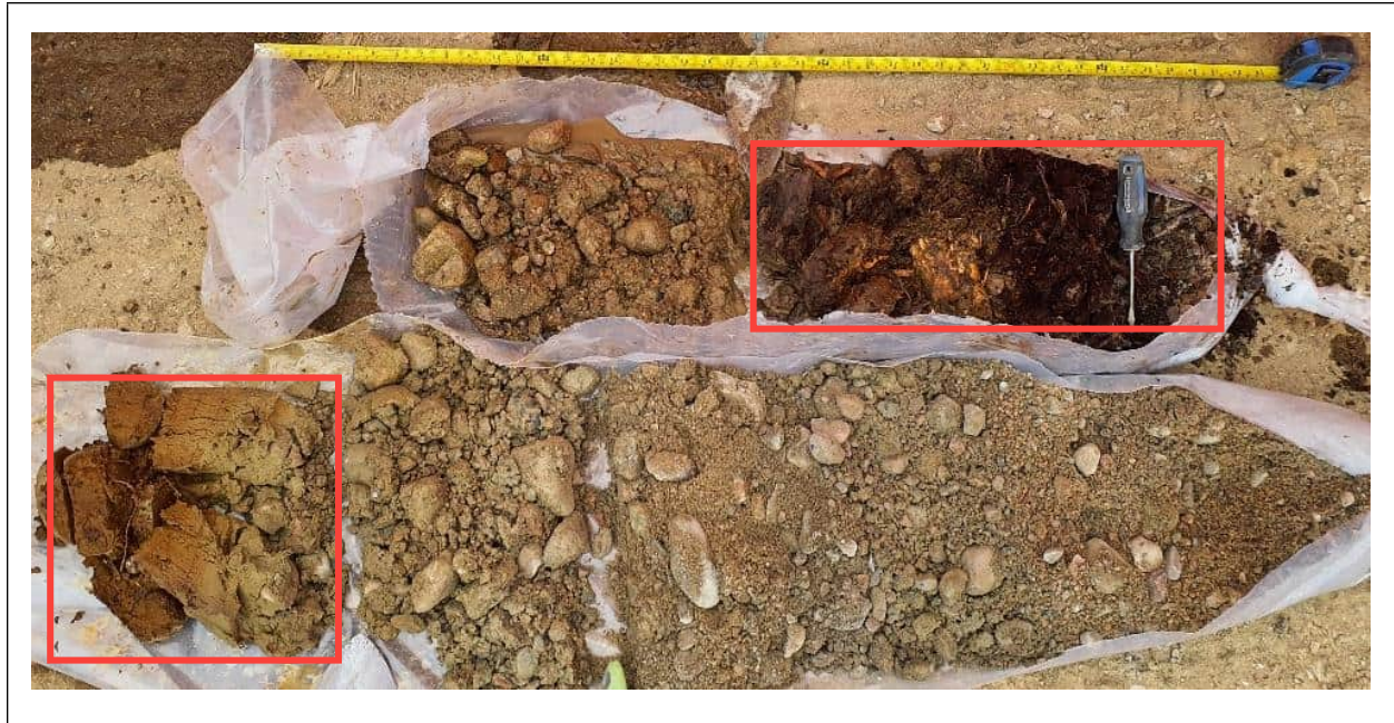
Figure 4-1 Échantillon CS-01 du forage 24F-02 – Remblai, tourbe, sol organique
