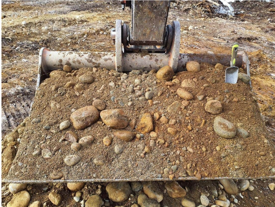
Figure 4-6 Dépôt pulvérulent moyen à grossier – Échantillon EM-04 de la tranchée 24TR-04
