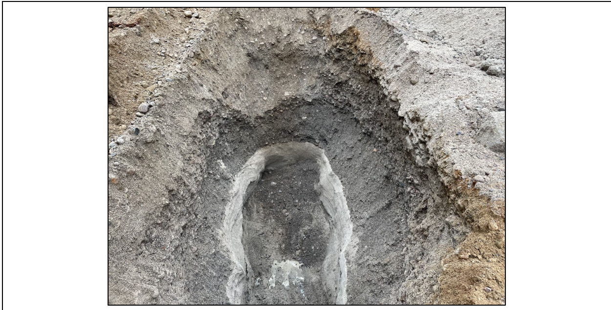
Figure 4 Banc B-6 : Unité de surface composée principalement de sable et gravier surmontant l'unité sableuse sus-jacente (TR-5).
