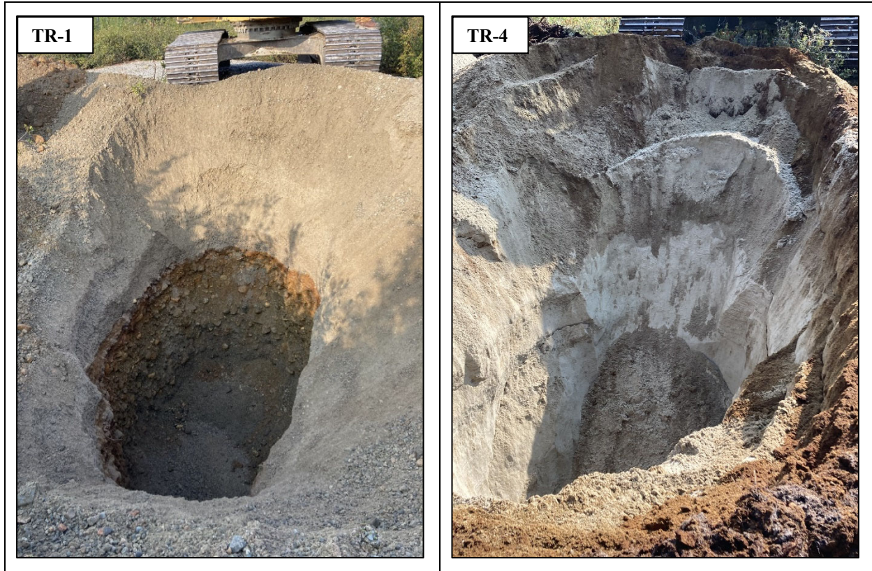
Figure 2 Banc B-3 : Deux unités sédimentaires dans la tranchée TR-1 et une seule unité sableuse dans la tranchée TR-4.
