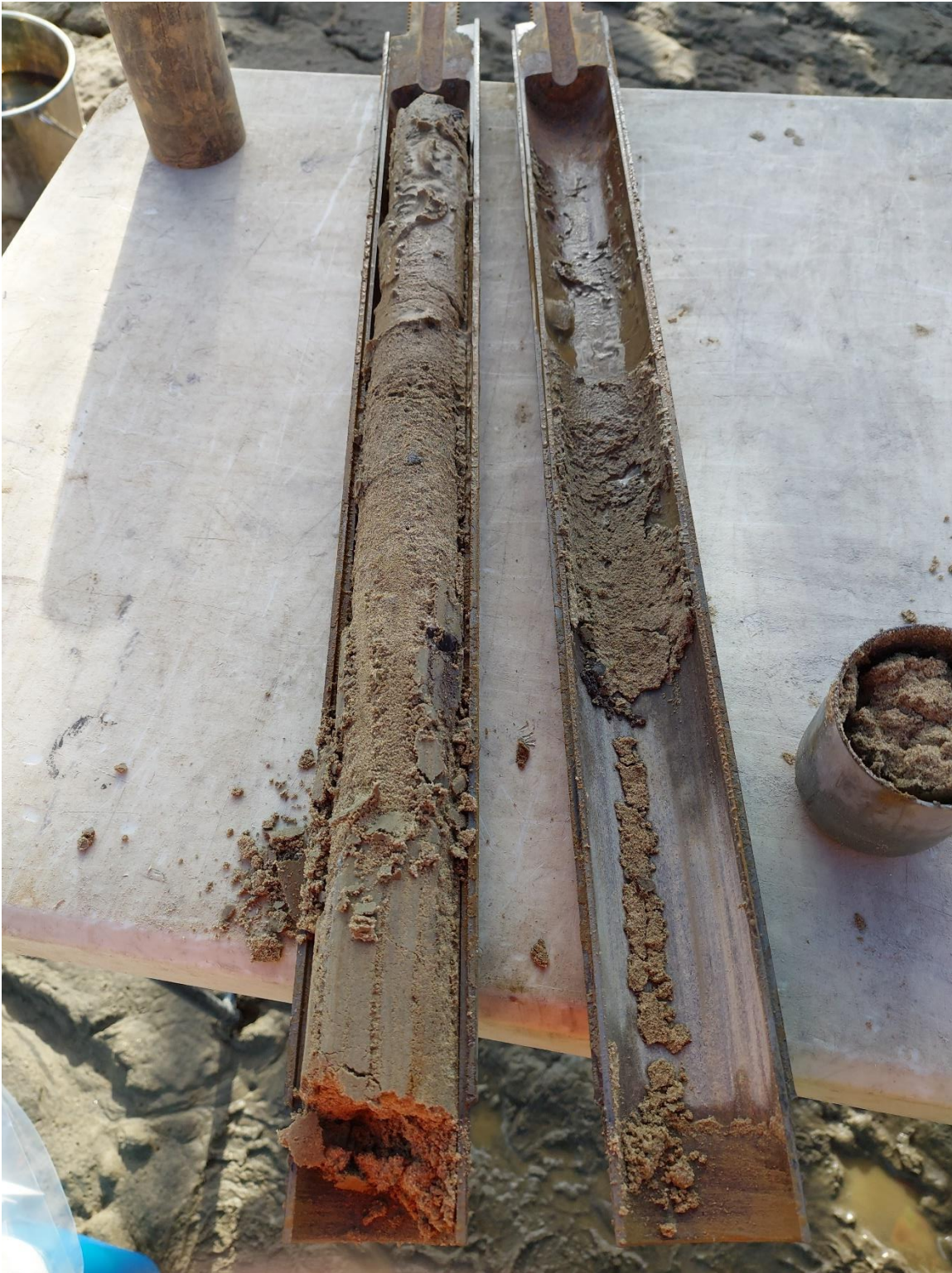
Photo 2 : Échantillonnage du sol – 26F01-CF01, Sable, traces de silt, de 0,00 m à 0,61 m de profondeur.
