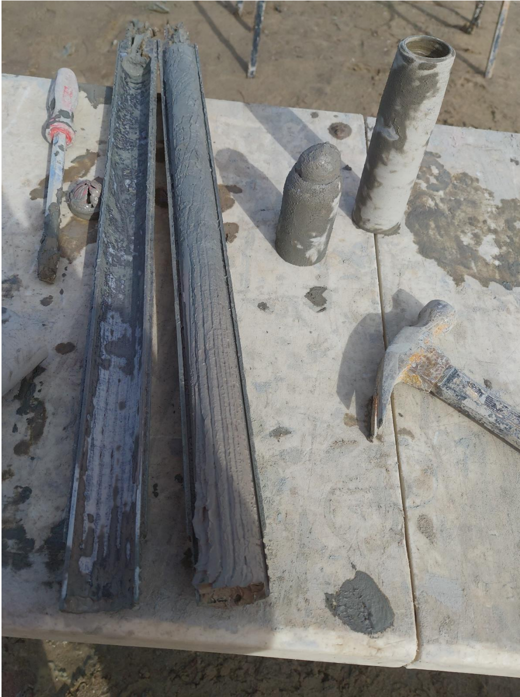
Photo 4 : Échantillonnage du sol – 26F03-CF10, Argile silteuse, de 5,49 m à 6,10 m de profondeur
