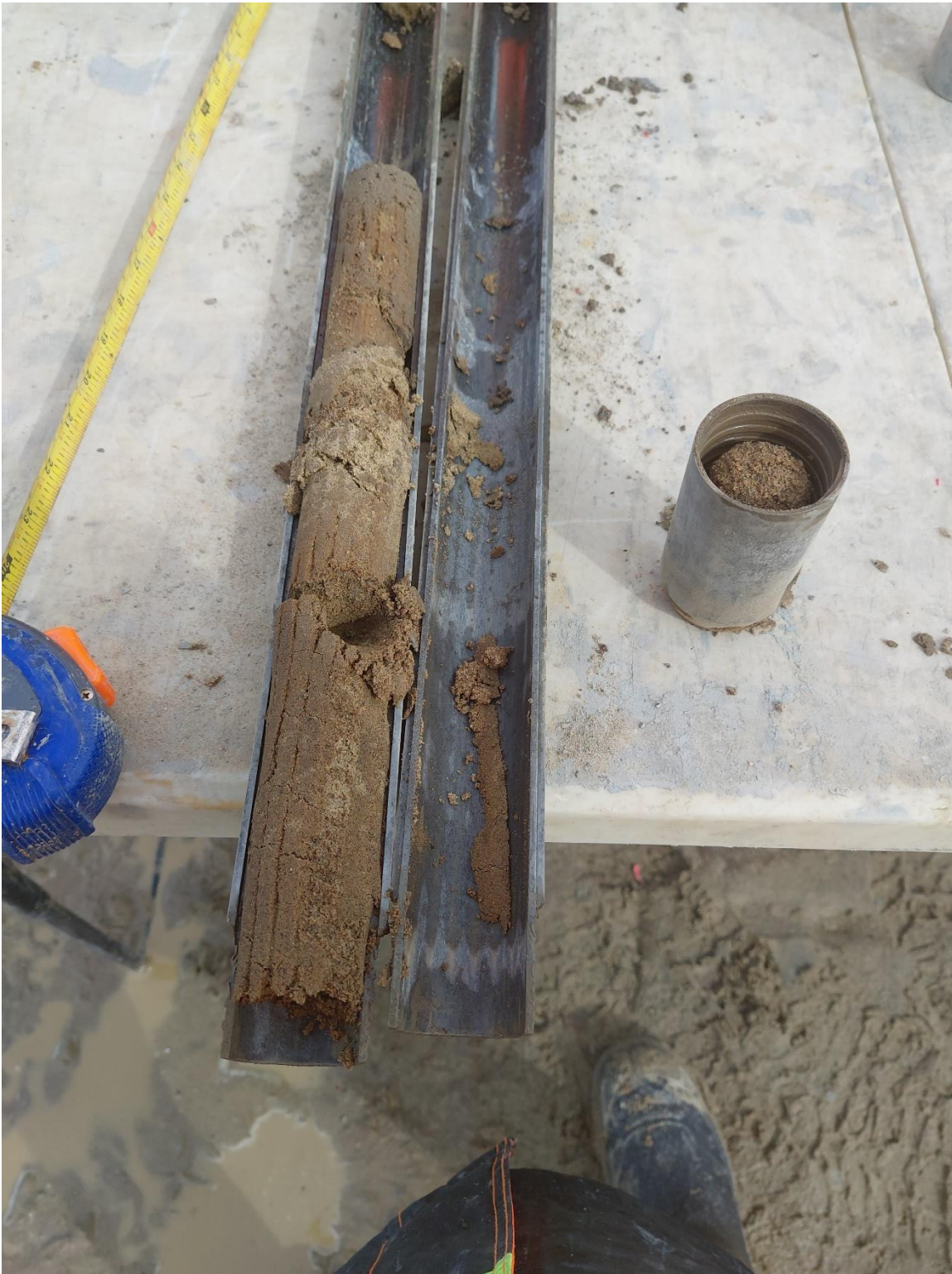
Photo 3 : Échantillonnage du sol – 26F03-CF04, Sable, traces de silt, de 1,83 m à 2,44 m de profondeur
