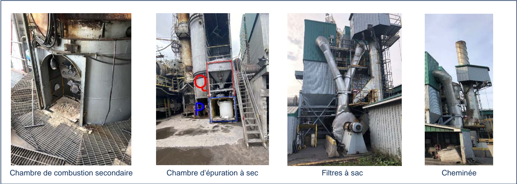
Figure 22 : Procédé de désorption thermique
