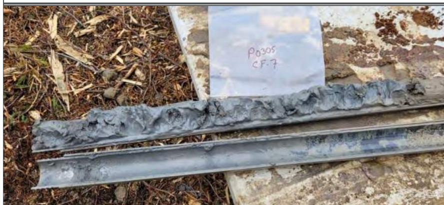
Photo 8 : PO-305 – CF7 horizon de silt sableux gris, avec un peu d'argile
