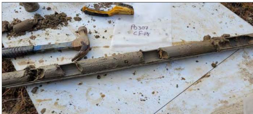
Photo 7 : PO-307 – CF13 Silt sableux gris, interlits de sable
