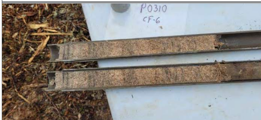
Photo 5 : PO-310 – CF6 Sable moyen à fin, brun, légèrement oxydé, petits interlits noirs
