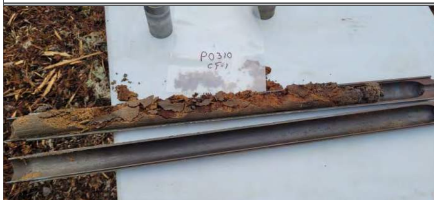
Photo 2 : PO-310 – CF1 Sable fin brun orangé, oxydé
