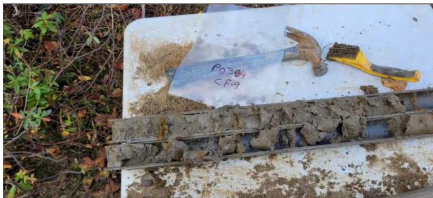
Photo 4 : PO-304 – CF9 Sable silteux argileux, gris brun
