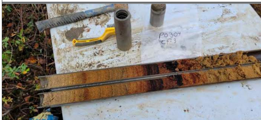
Photo 3 : PO-304 – CF3 Sable fin à moyen brun avec interlits noirs, très oxydé
