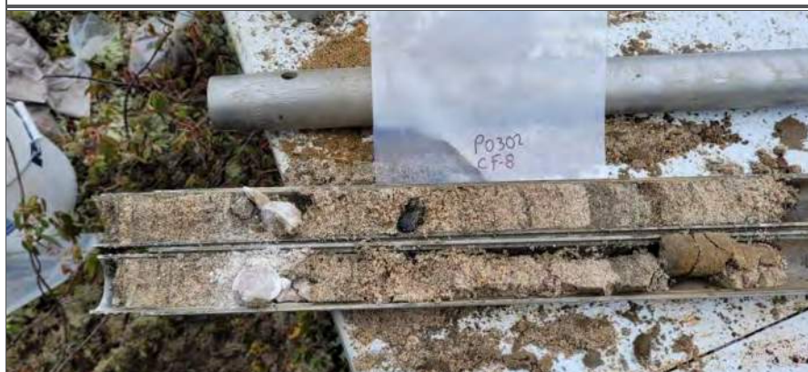
Photo 6 : PO-302 – CF8 Sable moyen à fin, brun, un peu de gravier, présence de cailloux
