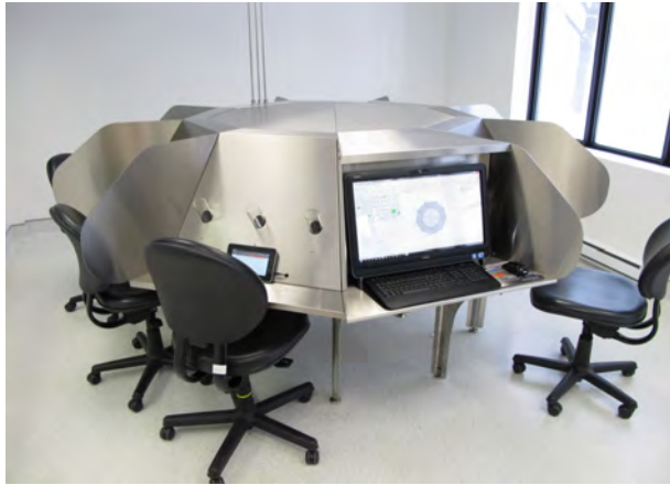
Figure 7 : Olfactomètre dynamique ONOSE-8 ®
