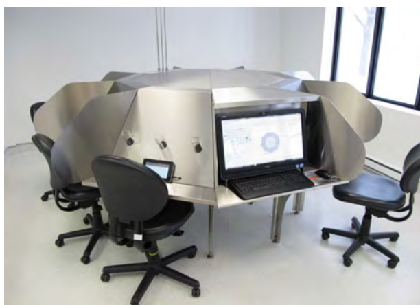
Figure 5 : Olfactomètre dynamique ONOSE-8 ®
