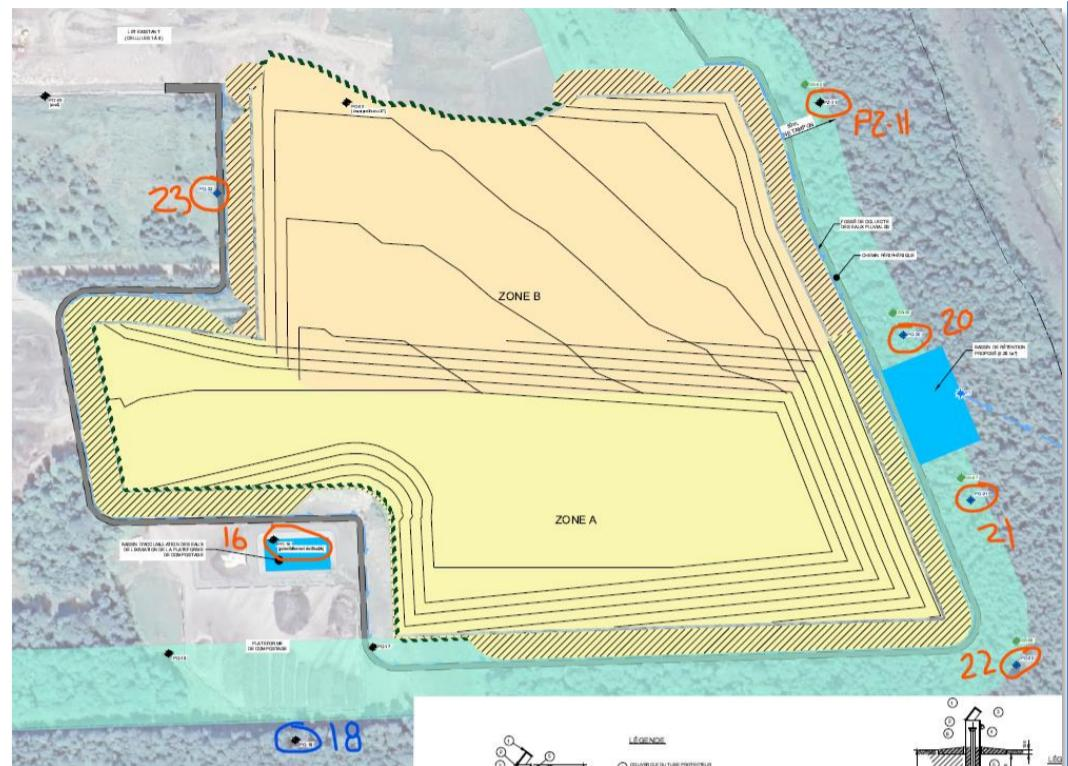
Le rapport hydrogéologique (Alphard - 2021) mentionne la présence d'un dôme piézométrique dans la partie sud du site, sous la plateforme de compostage, et est concordant avec la surface topographique (LIDAR). Ce dôme est schématisé aux annexes 6.1 (plus bas), 6.2 et 6.3.
