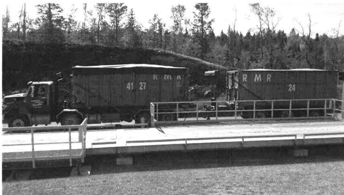
Camion porte-conteneur et semi-remorque (roll-off) – Longueur : 21 mètres
