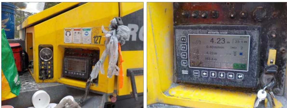
Photos 3.2: Système d'instrumentation des paramètres de forage sur foreuse Atlas Copco Roc D9.
