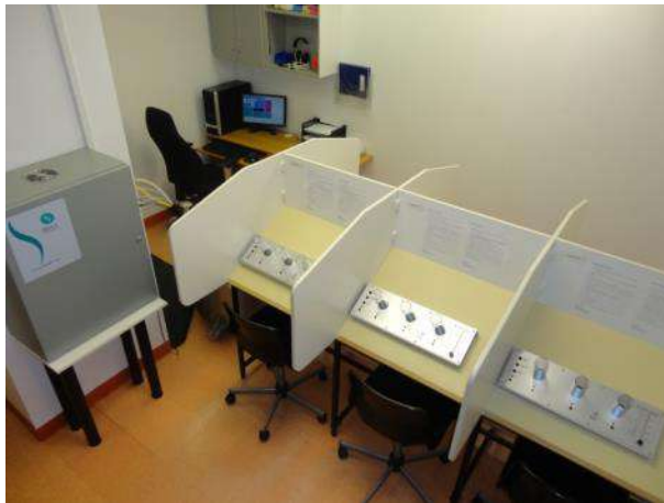
Figure F-3 Olfactomètre à dilution dynamique : salle du jury
