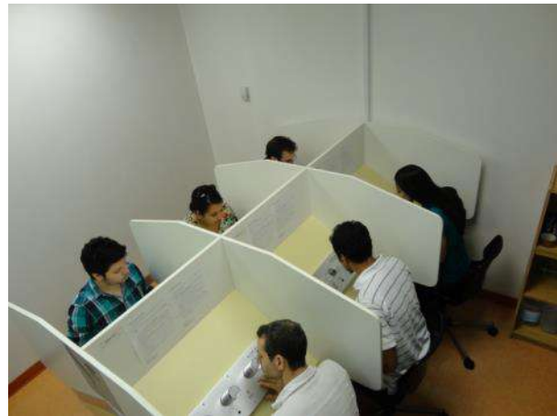
Figure F-4 Olfactomètre à dilution dynamique : poste de flairage des odeurs
