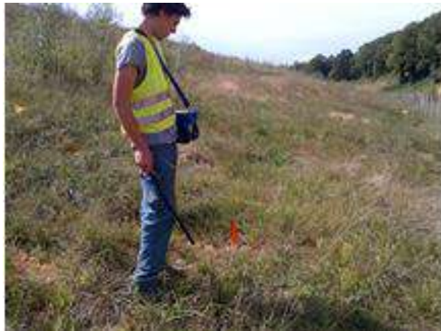
Figure C-1 : Mesure des concentrations de \text{CH}_4 en surface avec un TVA - 1000B
