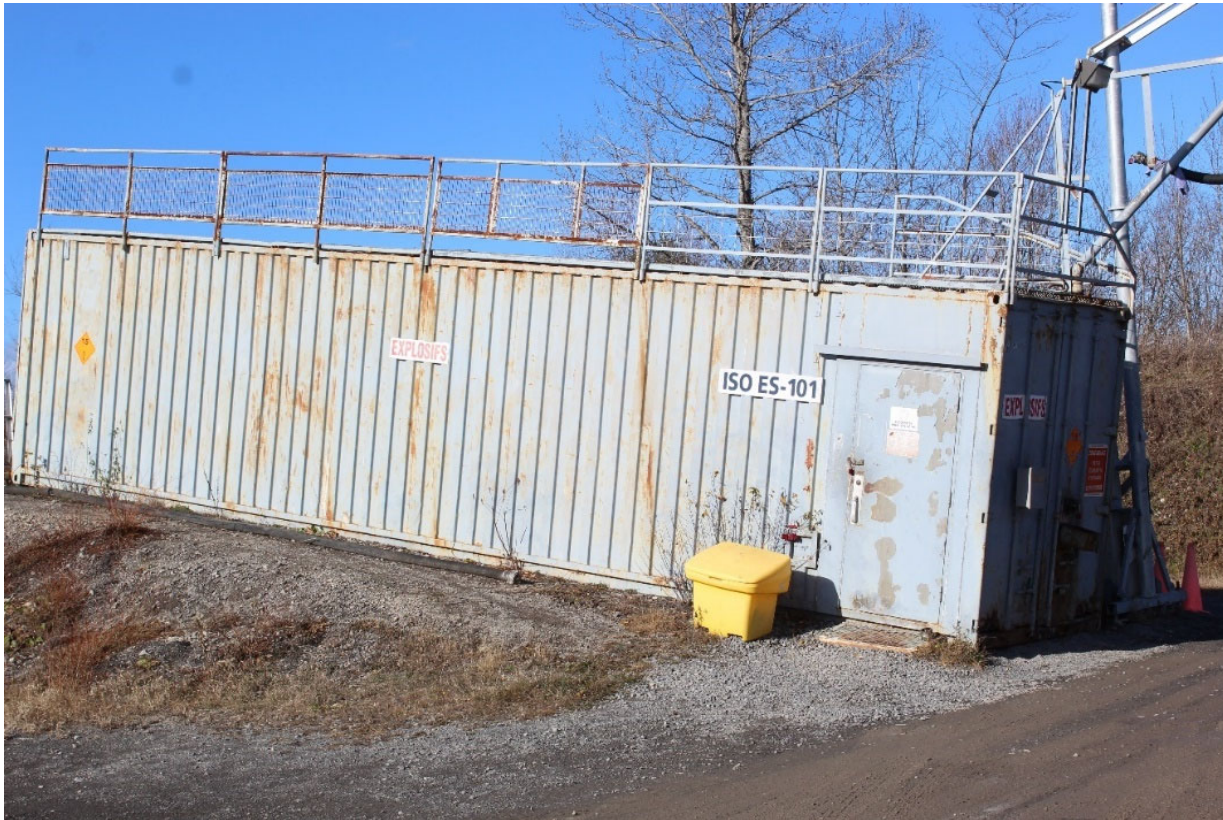
Figure 29 : Conteneur-citerne dédié à l'entreposage d'explosif liquide (ISO ES-101)
