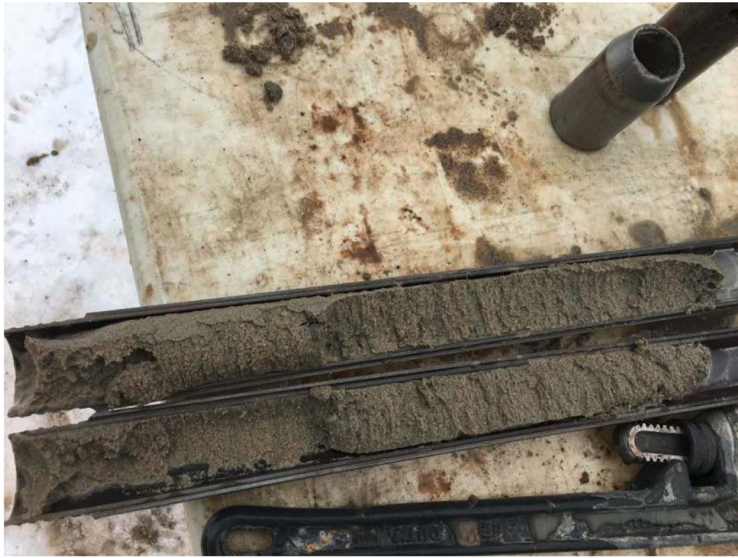
Photo 36 : Échantillons de roc entre 12,5 et 18 m de profondeur au PZ-01R
