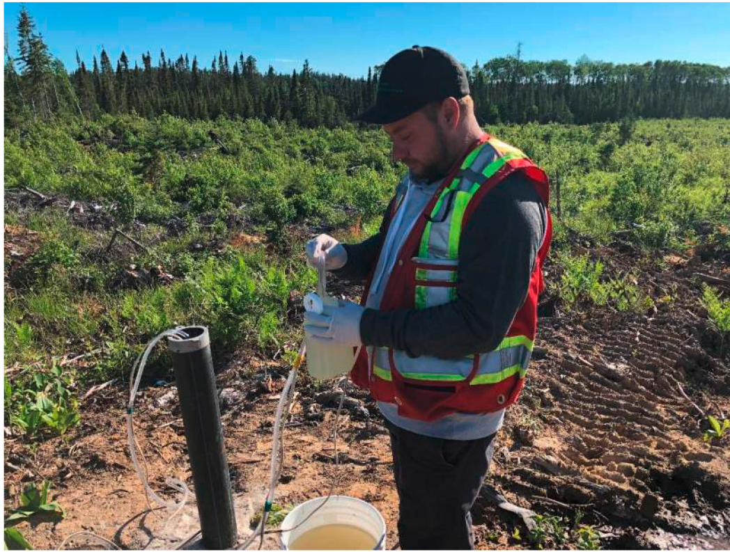
Photo 56 : Mise en place d'une sonde Levellogger
