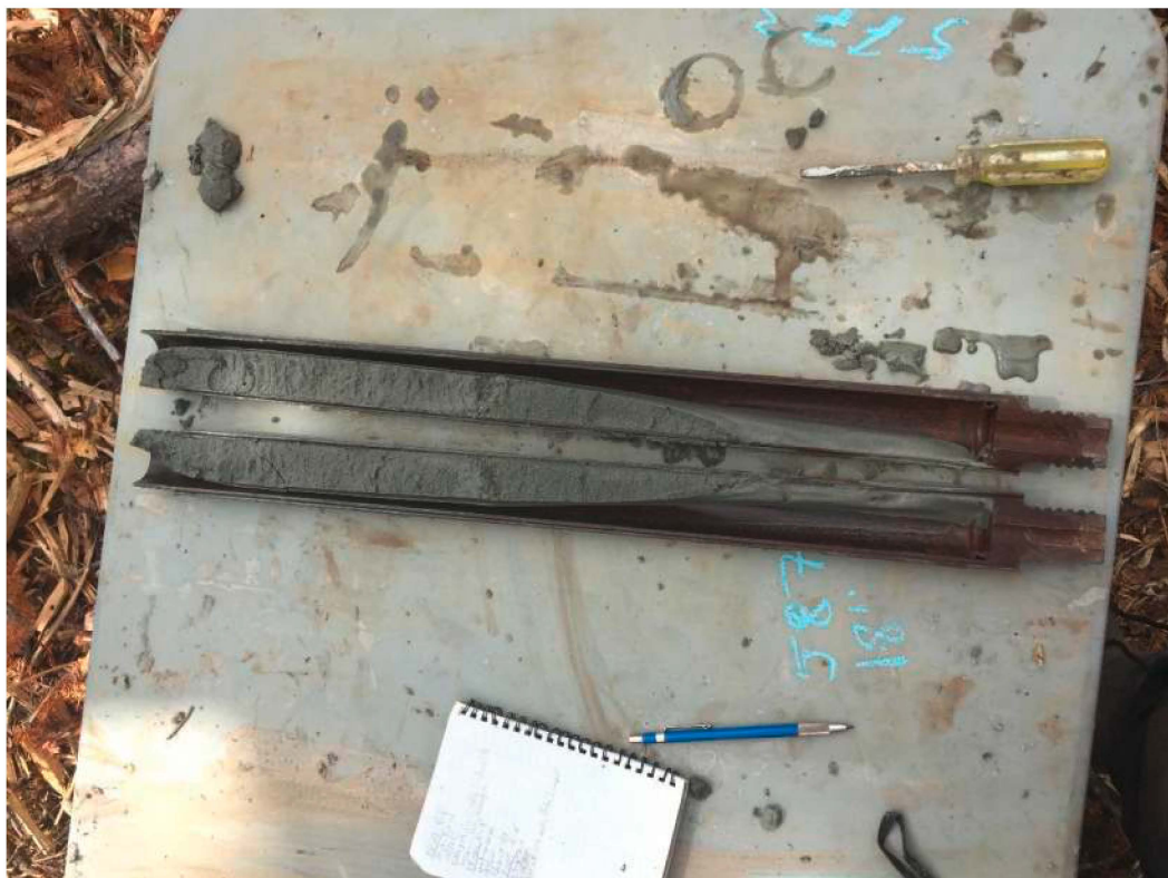
Photo 18 : Échantillon de sol provenant du forage PZ-09-MT
