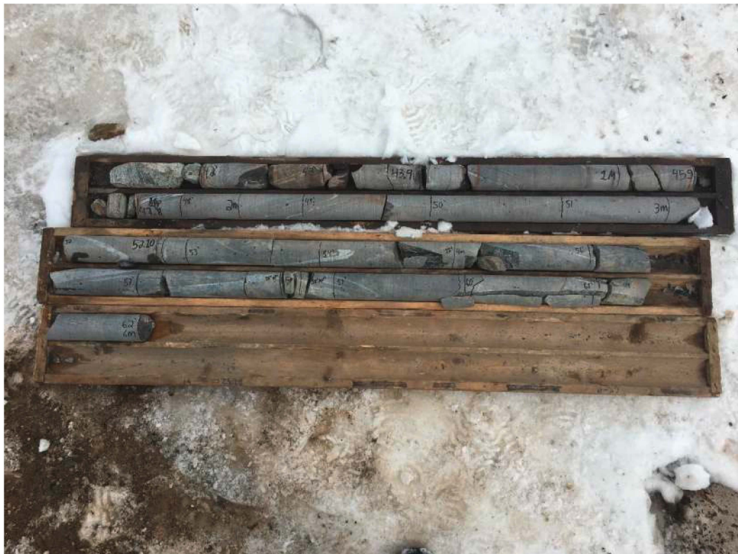
Photo 36 : Échantillons de roc entre 12,5 et 18 m de profondeur au PZ-01R
