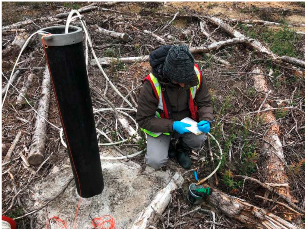
Photo 60 : Mesure des paramètres physico-chimiques lors de la purge
