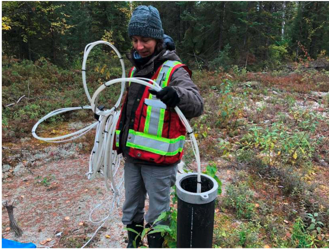
Photo 60 : Mesure des paramètres physico-chimiques lors de la purge
