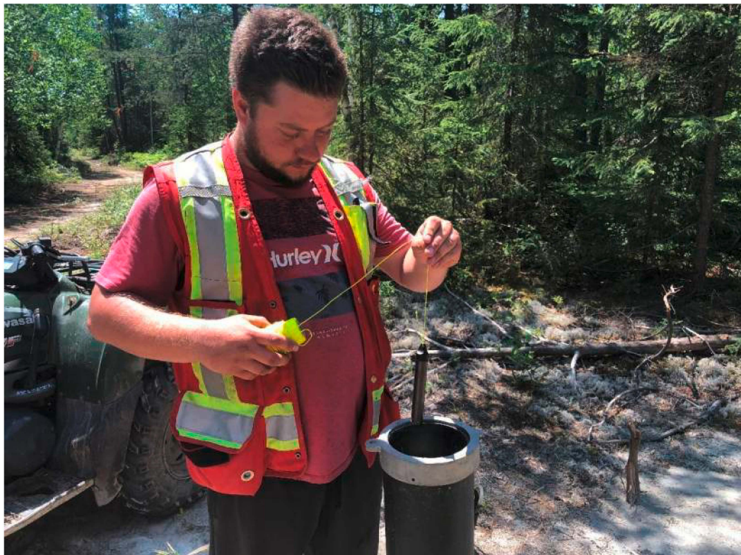
Photo 56 : Mise en place d'une sonde Levellogger
