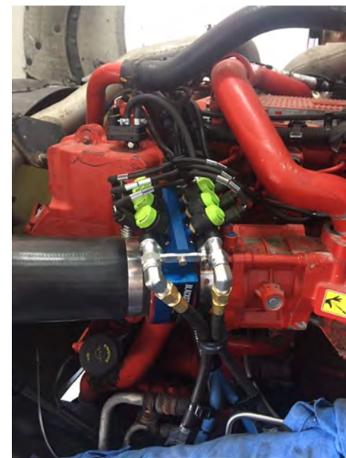
Système d'injection de gaz naturel sur un moteur diesel
