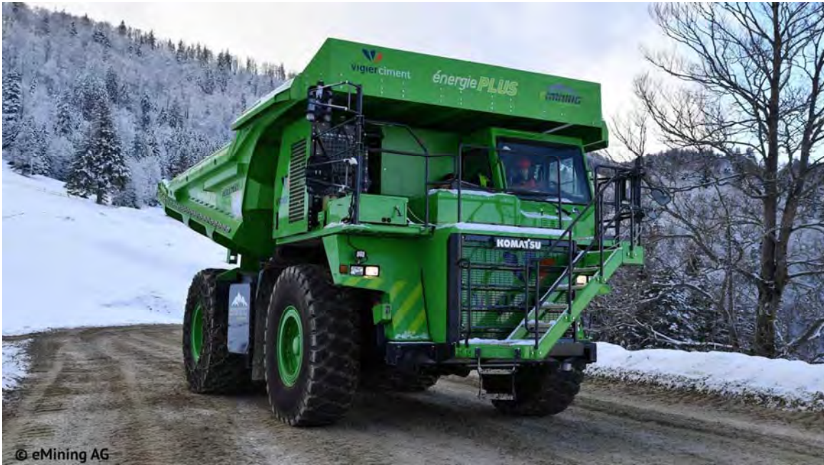
Figure 3: E-Dumper, conversion électrique d'un Komatsu HB605-7 par EMining AG, [22]
