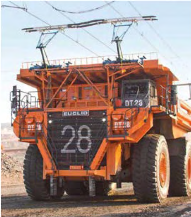
Figure 2: Système de pantographe et caténaire, sur un camion minier en trolley assist [17]
