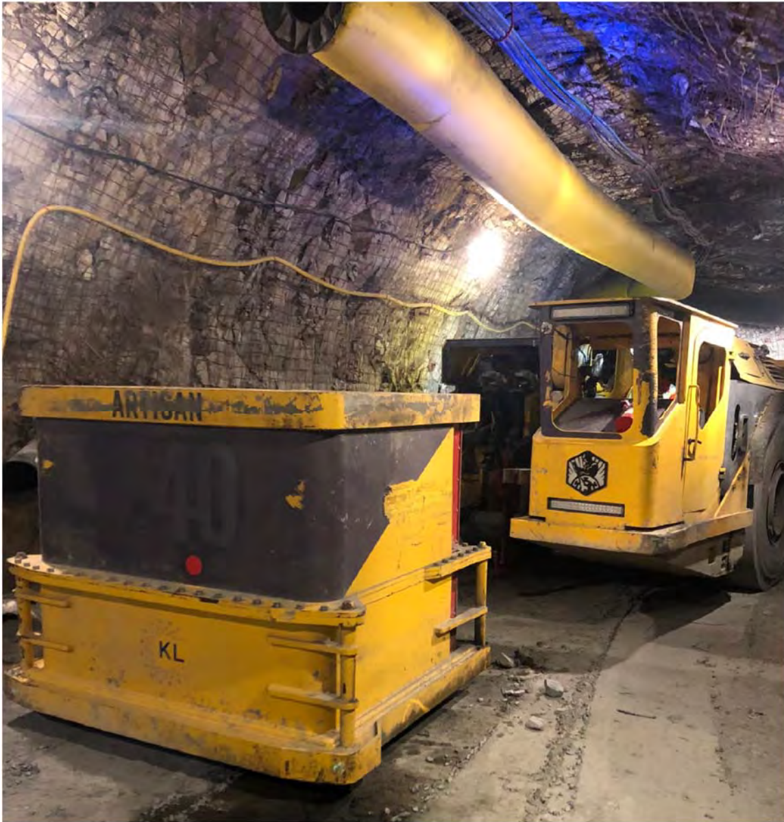
Figure 1: Véhicule Z40 d'Artisan, en service à la mine Macassa de Kirkland Lake, effectuant un remplacement de sa batterie (avant gauche) [15]
