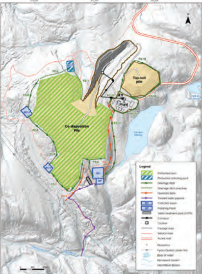
Figure 6.10 Halde projetée sur 25.5 ans et fermeture
