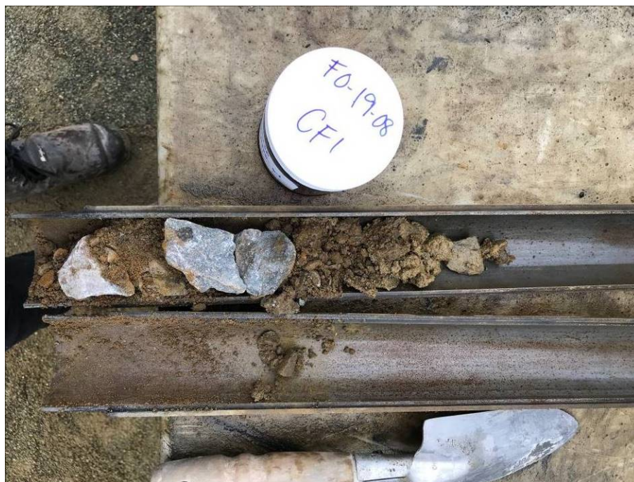
Photo 14 Récupération de matériaux dans une cuillère fendue lors des forages, forage FO-19-08 (3 octobre 2019).
