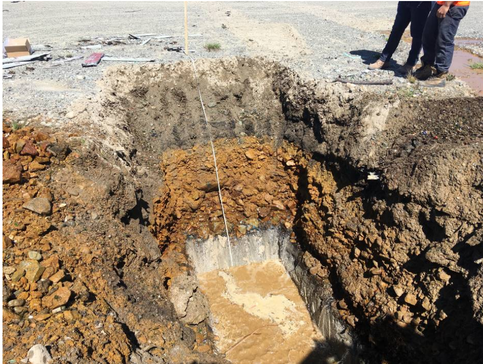
Photo 1 Exemple de matériaux de remblai rencontrés sur le site, tranchée TR-19-37 (28 mai 2019).
