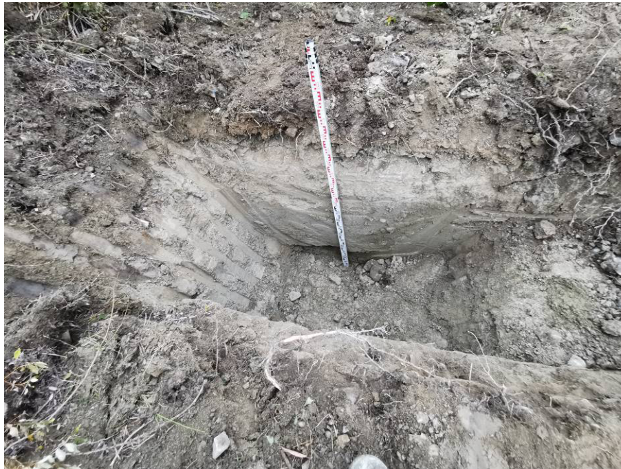
Photo 9 Présence de stérile minier en surface (horizon 5 à 15 cm), tranchée 20TR-EF-2225 (9 septembre 2020).
