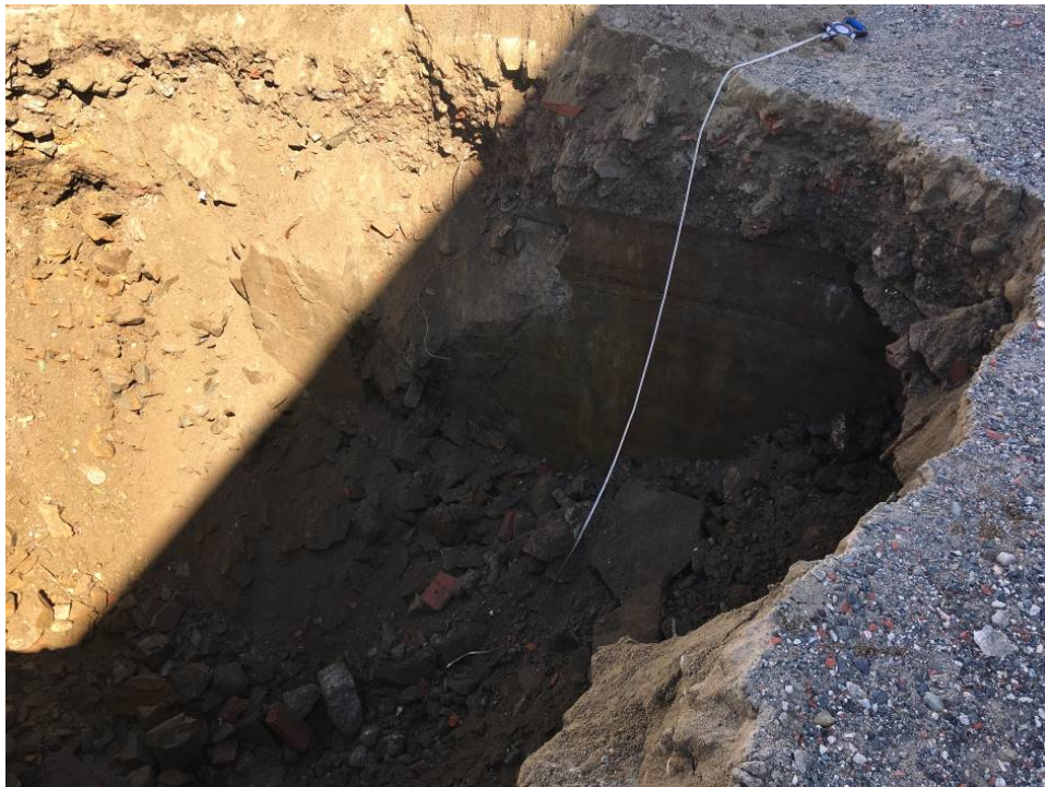
Photo 2 Exemple de matières résiduelles (briques, fil, métal) rencontrées sur le site, tranchée TR-19-21 (28 mai 2019)
