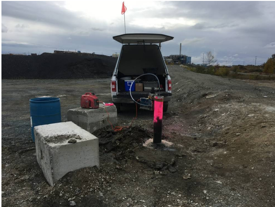
Photo 10 Développement du puits PO-19-01 (3 octobre 2019)
