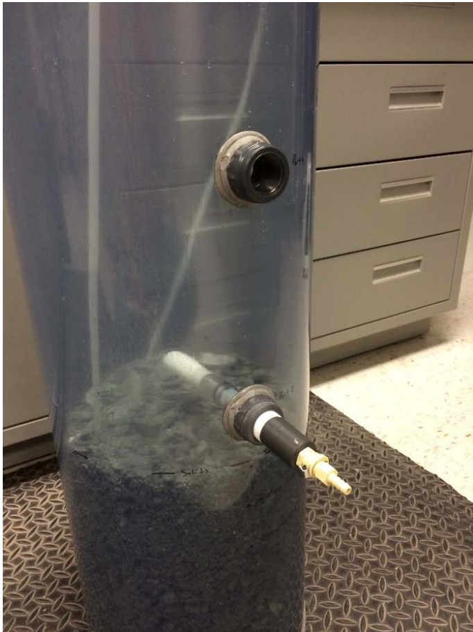
Figure 1: Colonne du test de lixiviation en condition submergée avant ennoisement, illustrant la position des ports 3 et 4.
