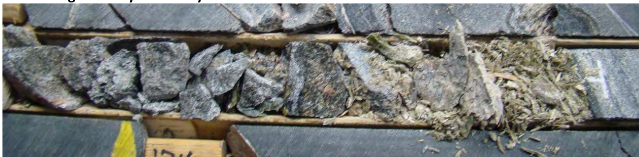
Image 33: Zone hautement fragmentée de la Boite #34 (172.35-172.75m).
