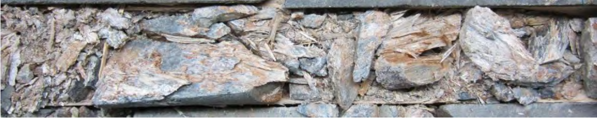
Image 46: Zone hautement fragmentée de la Boite #47 du trou 08-RN-94 (209.10-209.45m)
