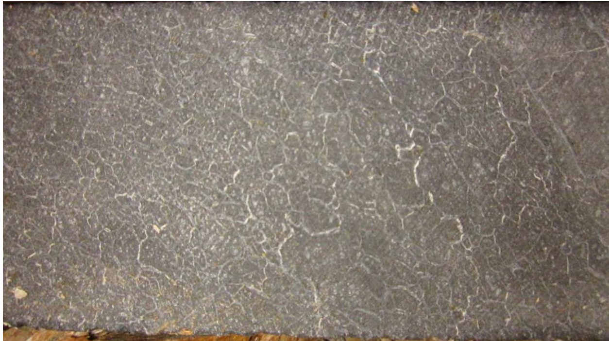
Image 24: Échantillon de la catégorie d'intensité Élevée sur la carotte de forage
