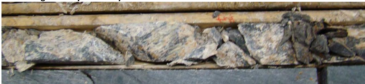
Image 32: Zone hautement fragmentée de la Boîte #80 (369.60-370.30m).
