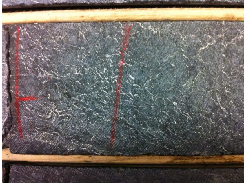
Image 2: Section du trou de forage 11-RN-309 boîte #88 avec un niveau de réseaux de chrysotile intense. Les mesures ont été prises au long des lignes rouges perpendiculairement au réseau de chrysotile.
