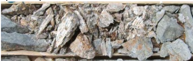
Image 47: Zone hautement fragmentée de la Boîte #47 du trou 08-RN-94 (208.5-208.65m)
