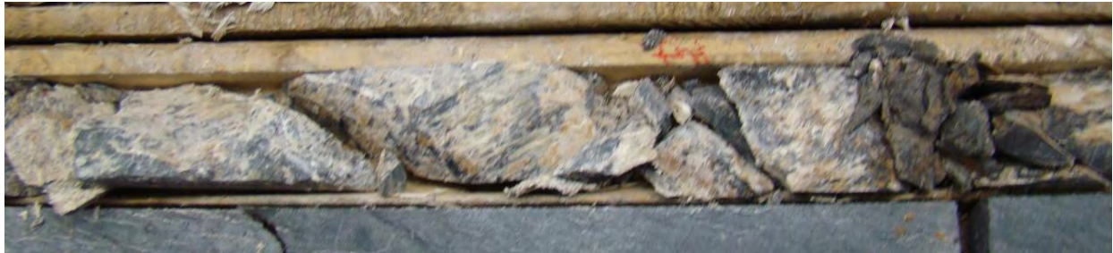
Image 32: Zone hautement fragmentée de la Boite #80 (369.60-370.30m).
