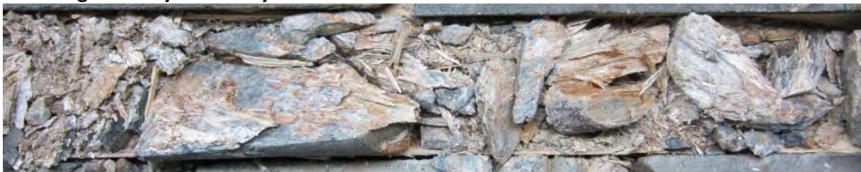
Image 45: Zone hautement fragmentée de la Boîte #47 du trou 08-RN-94 (209.10-209.45m)
