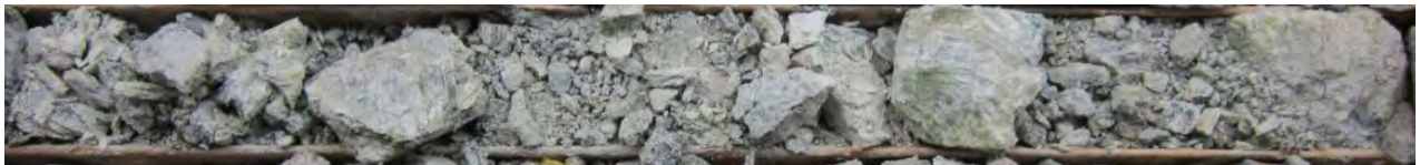
Image 45: Zone hautement fragmentée de la Boîte #3 du trou 11-RN-296 (63.49-63.97m)
