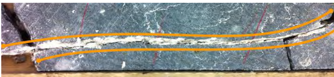
Figure 17: Veine de chrysotile subparallèle à l'axe de la carotte de forage
