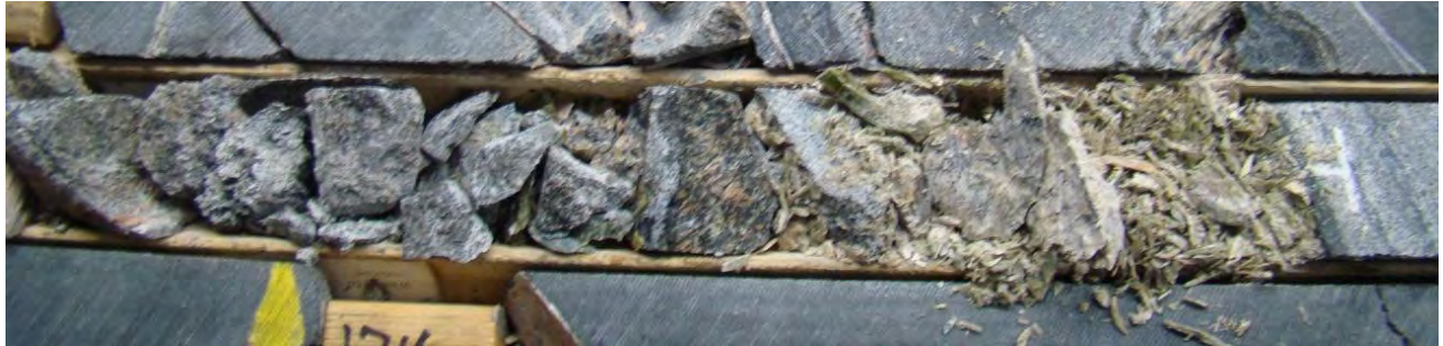
Image 33: Zone hautement fragmentée de la Boîte #34 (172.35-172.75m).
