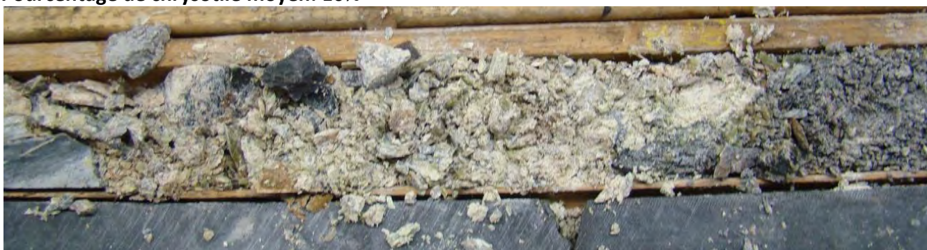
Image 34: Zone hautement fragmentée de la Boite #49 (236.50-237.00m).
