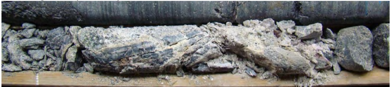
Image 40: Zone hautement fragmentée de la Boîte #26 (139.75-140.35m).
