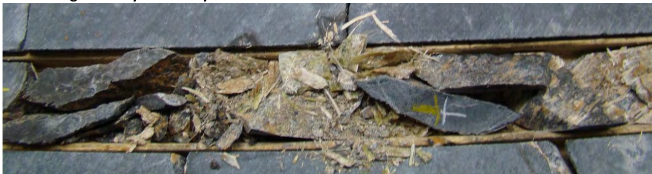
Image 27: Zone hautement fragmentée de la Boite #61 (289.90-290.40m)
