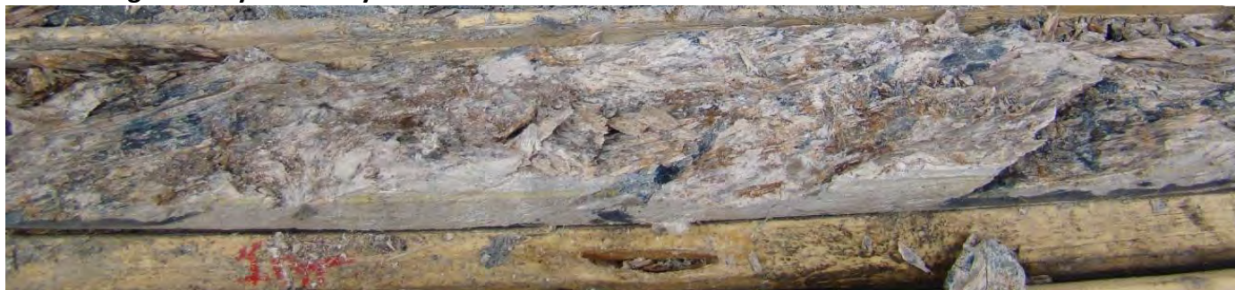
Image 41: Zone hautement fragmentée de la Boite #97 (446.20-446.80m).
