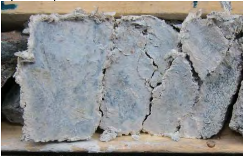
Image 49: Zone hautement fragmentée de la Boite #18 du trou 11-RN-300 (115.03-115.11m)
