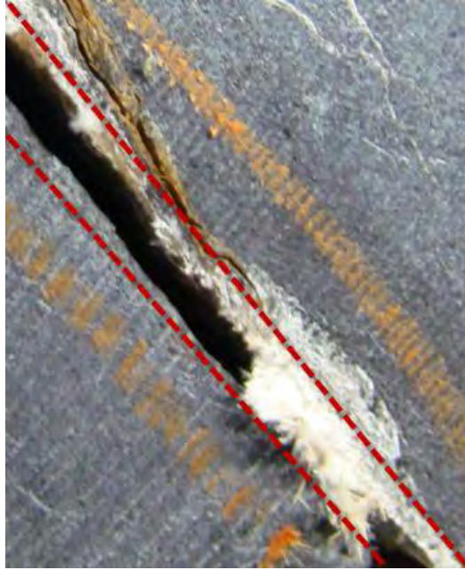
Image 51: Veine coupant le diamètre de la carotte de forage à un angle faible. L'épaisseur est mesurée avec une règle.
