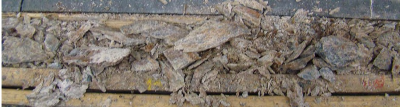
Image 37: Zone hautement fragmentée de la Boite #97 (445.80-446.20m).
