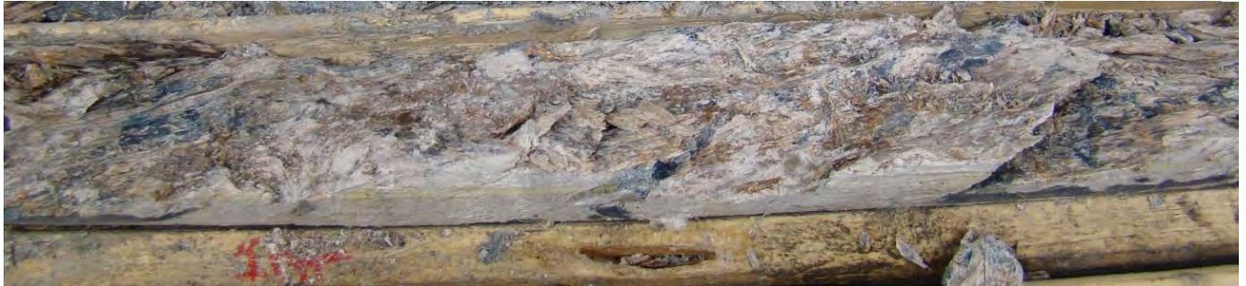
Image 41: Zone hautement fragmentée de la Boite #97 (446.20-446.80m).
