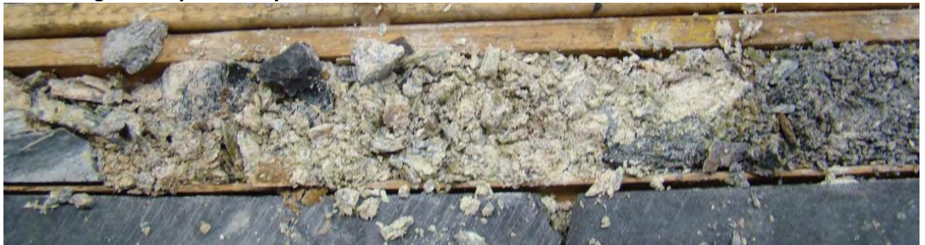
Image 34: Zone hautement fragmentée de la Boîte #49 (236.50-237.00m).
