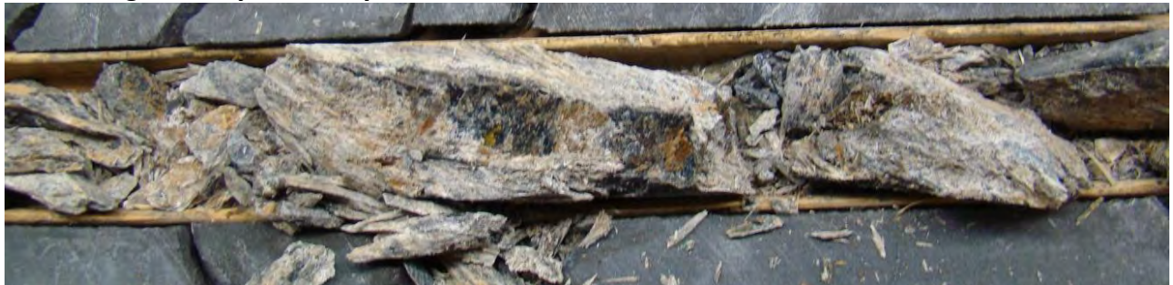
Image 38: Zone hautement fragmentée de la Boite #104 (474.15-474.75m).
