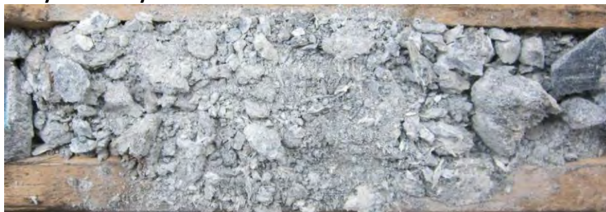
Image 46: Zone hautement fragmentée de la Boîte #4 du trou 11-RN-252 (43.10-43.32m)
