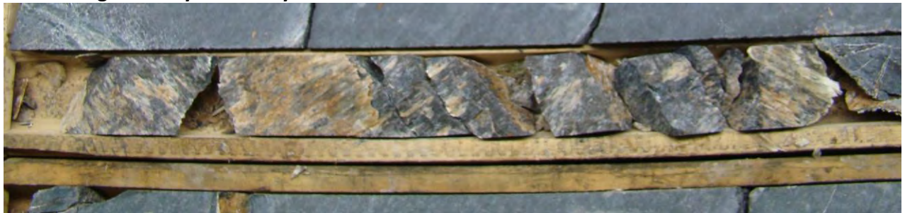
Image 28: Zone hautement fragmentée de la Boite #61 (290.40-291.00m)
