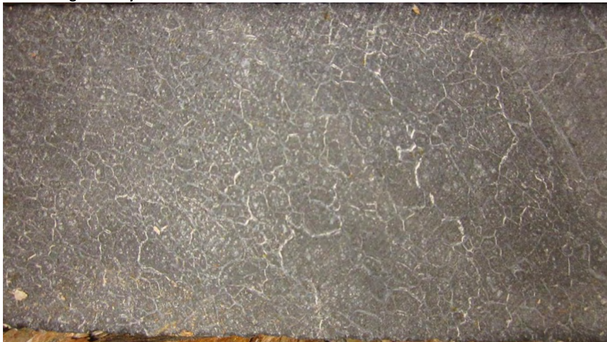
Image 24: Échantillon de la catégorie d'intensité Élevée sur la carotte de forage
