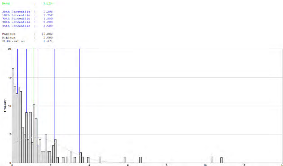
Figure 27: Histogramme des pourcentages de chrysotile dans la péridotite inférieure
