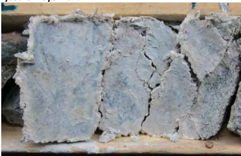
Image 48: Zone hautement fragmentée de la Boîte #18 du trou 11-RN-300 (115.03-115.11m)
