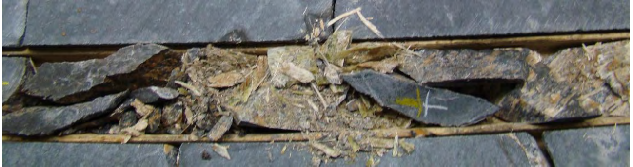
Image 27: Zone hautement fragmentée de la Boite #61 (289.90-290.40m)
