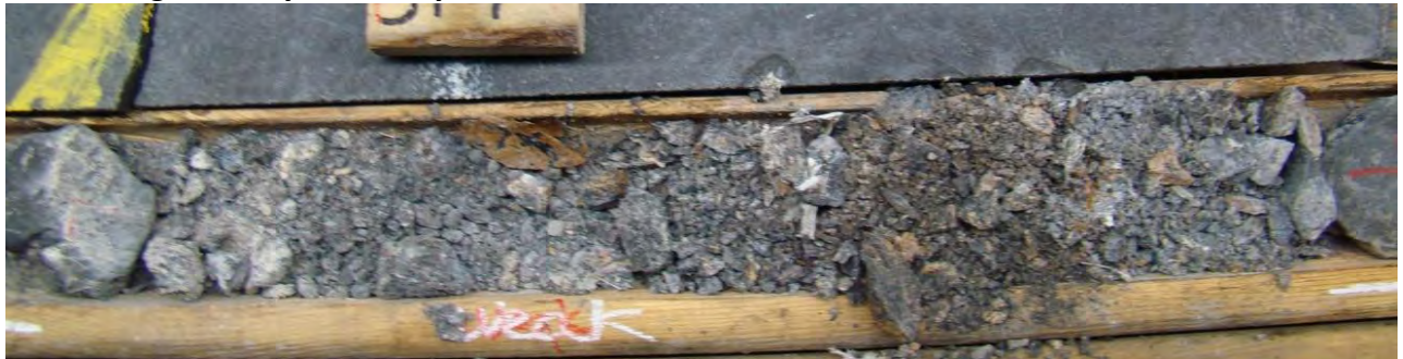
Image 30: Zone hautement fragmentée de la Boite #114 (518.85- 519.10m).
