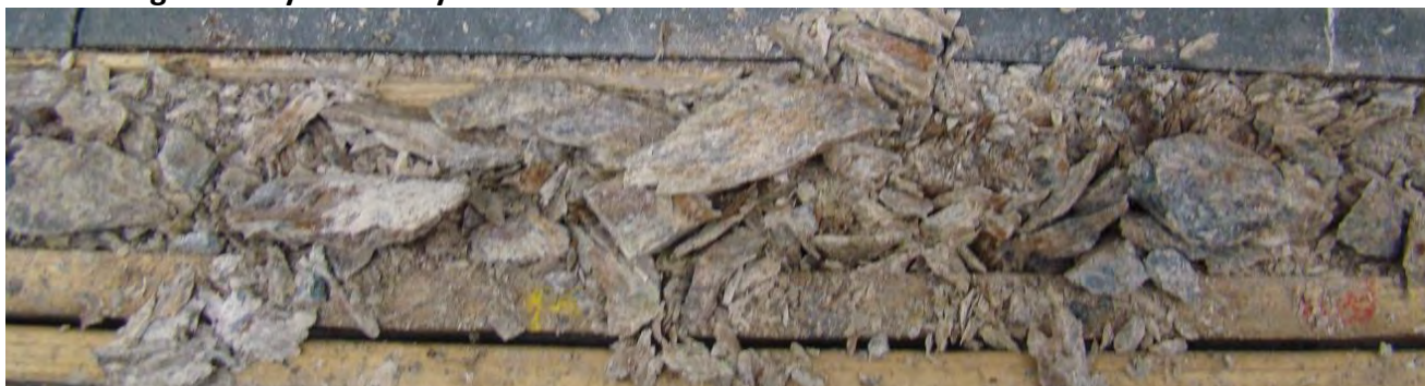
Image 37: Zone hautement fragmentée de la Boite #97 (445.80-446.20m).
