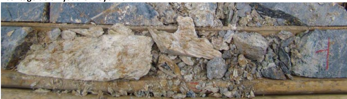
Image 42: Zone hautement fragmentée de la Boite #63 (299.20-299.50m)
