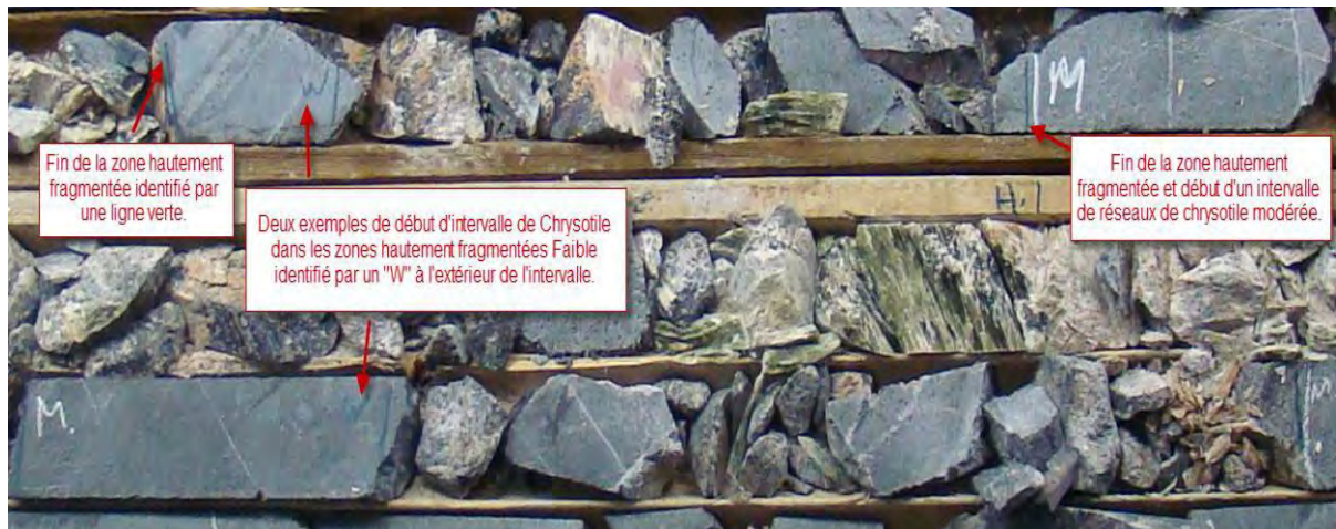
Figure 16: Exemple de délimitation du chrysotile dans les zones hautement fragmentées
