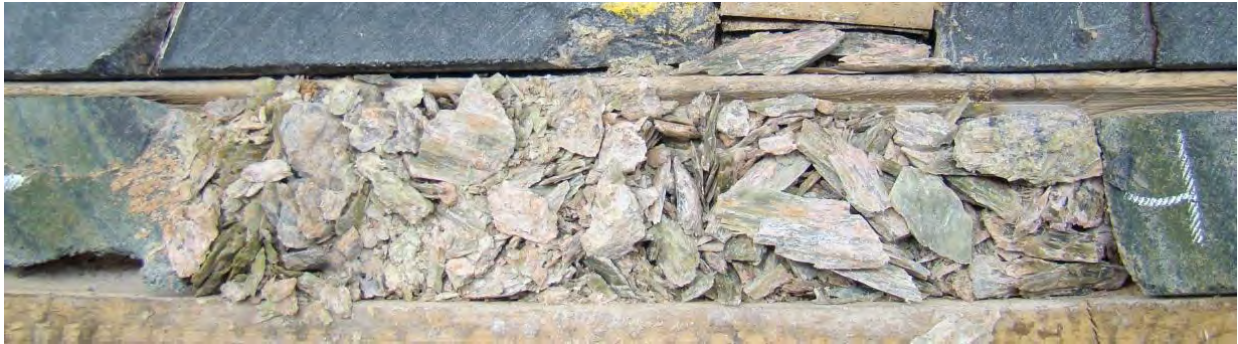
Image 29: Zone hautement fragmentées de la Boite #35 (178.20-178.50m).
