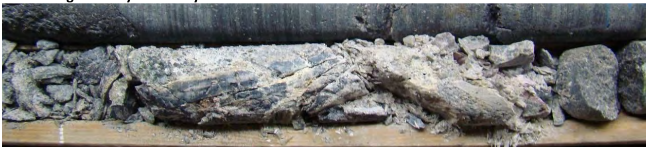
Image 40: Zone hautement fragmentée de la Boîte #26 (139.75-140.35m).
