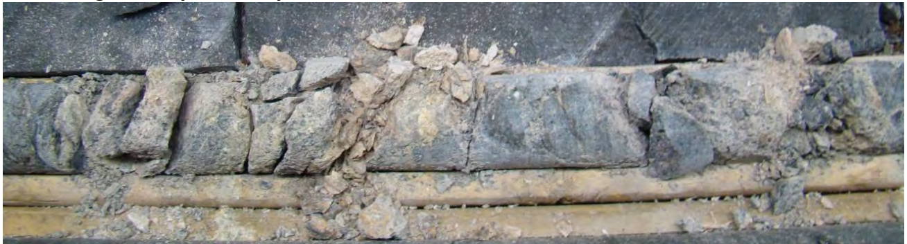
Image 39: Zone hautement fragmentée de la Boîte #24 (131.40-131.95m)
