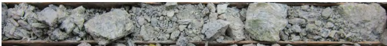
Image 44: Zone hautement fragmentée de la Boîte #3 du trou 11-RN-296 (63.49-63.97m)
