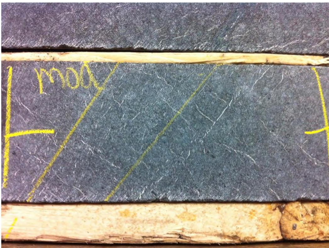
Image 1: Section du trou de forage 11-RN-309 boîte #57 avec un niveau de réseaux de chrysotile modérées. Les mesures ont été prises au long des lignes jaunes perpendiculairement au réseau de chrysotile.
