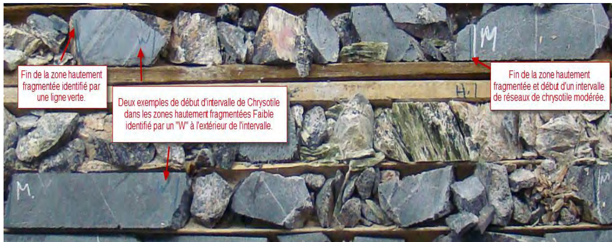
Figure 15: Exemple de délimitation du chrysotile dans les zones hautement fragmentées
