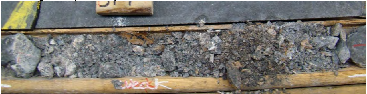
Image 30: Zone hautement fragmentée de la Boite #114 (518.85- 519.10m).
