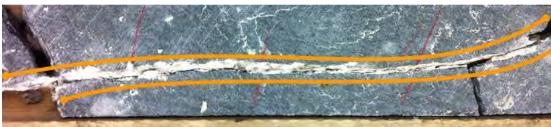
Figure 18: Veine de chrysotile subparallèle à l'axe de la carotte de forage
