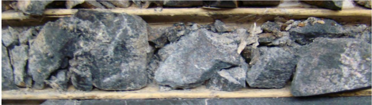
Image 31: Zone hautement fragmentée de la Boite #115 (521.50-522.00m).
