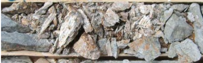
Image 48: Zone hautement fragmentée de la Boite #47 du trou 08-RN-94 (208.5-208.65m)
