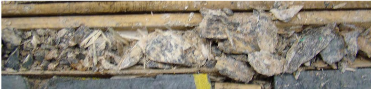
Image 36: Zone hautement fragmentée de la Boîte #80 (370.30-370.80m).
