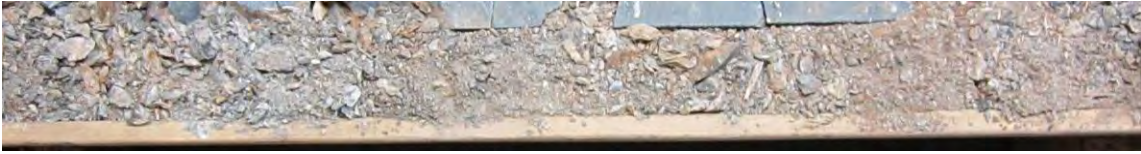
Image 43: Zone hautement fragmentée de la Boîte #67 du trou 11-RN-334 (312.38-313.00m)
