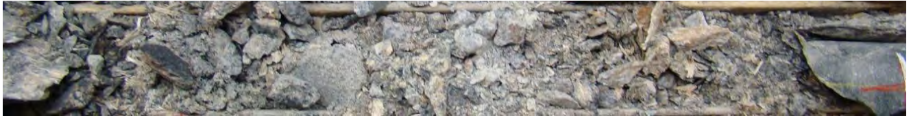
Image 35: Zone hautement fragmentée de la Boite #115 (521.00-521.50m).
