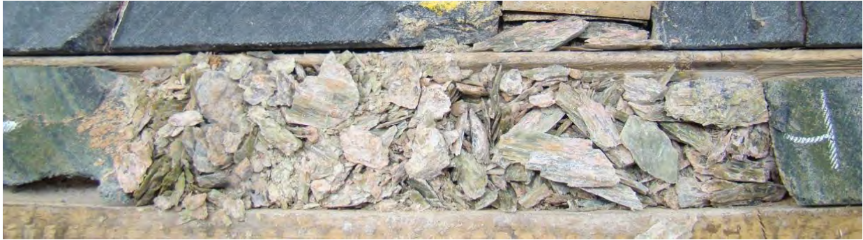
Image 29: Zone hautement fragmentées de la Boite #35 (178.20-178.50m).
