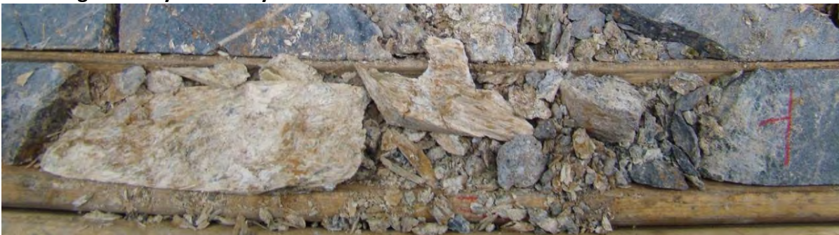
Image 42: Zone hautement fragmentée de la Boite #63 (299.20-299.50m)
