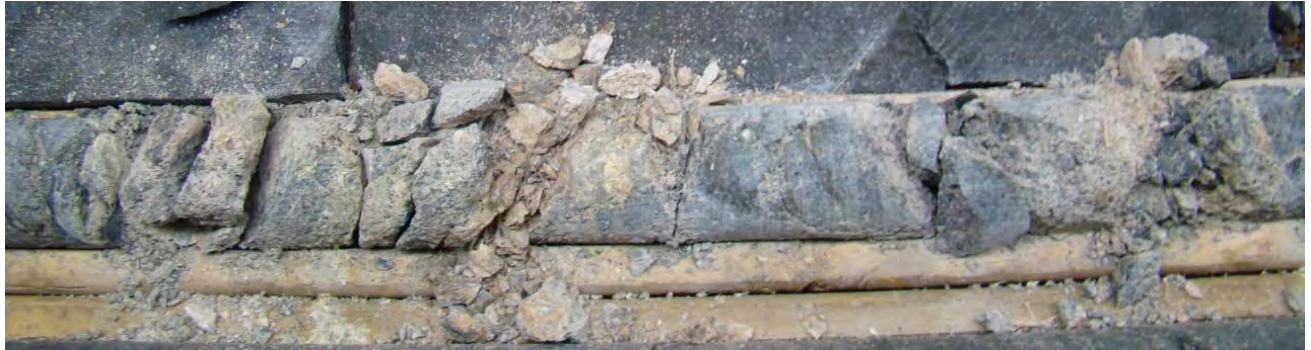
Image 39: Zone hautement fragmentée de la Boîte #24 (131.40-131.95m)
