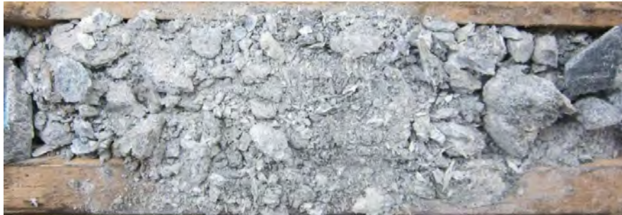
Image 47: Zone hautement fragmentée de la Boite #4 du trou 11-RN-252 (43.10-43.32m)
