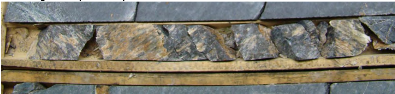
Image 28: Zone hautement fragmentée de la Boite #61 (290.40-291.00m)
