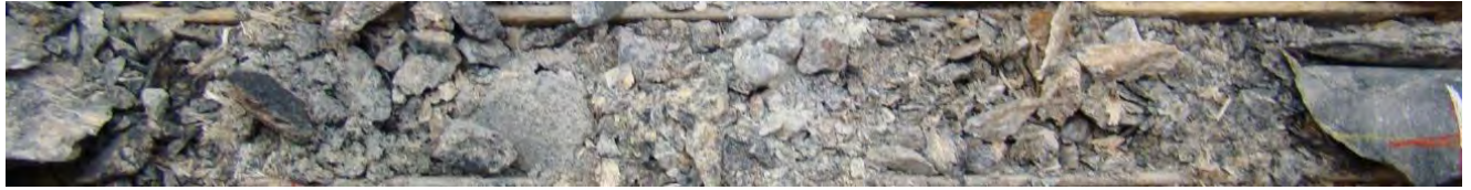
Image 35: Zone hautement fragmentée de la Boîte #115 (521.00-521.50m).
