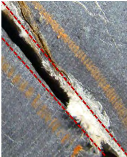
Image 50: Veine coupant le diamètre de la carotte de forage à un angle faible.
