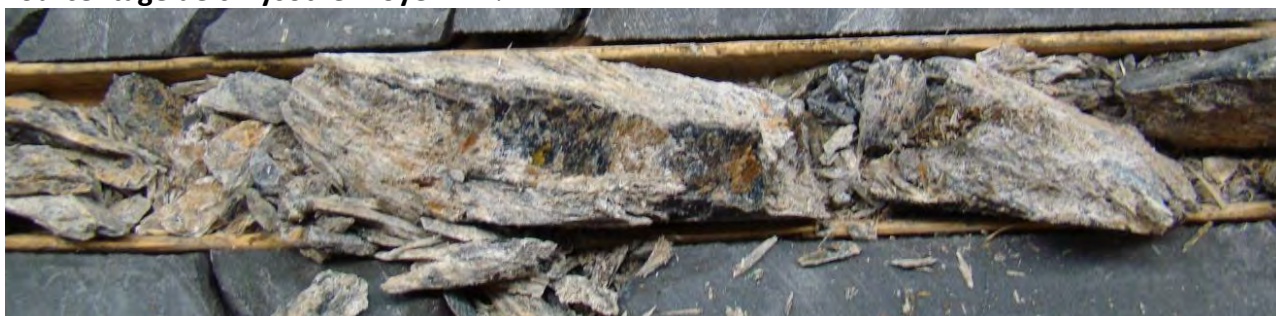
Image 38: Zone hautement fragmentée de la Boite #104 (474.15-474.75m).
