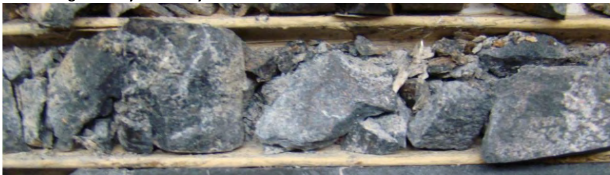
Image 31: Zone hautement fragmentée de la Boîte #115 (521.50-522.00m).
