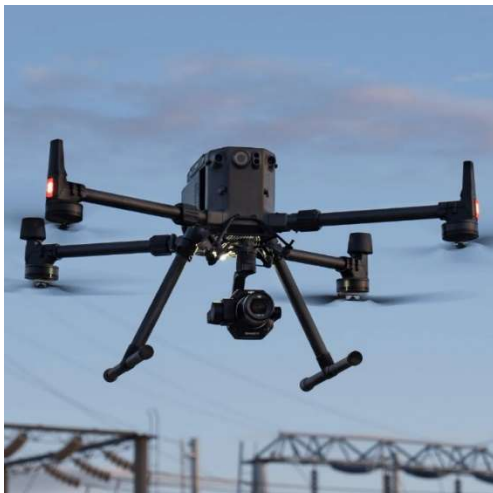
Figure 2 Drone utilisé pour la délimitation des herbiers aquatiques
