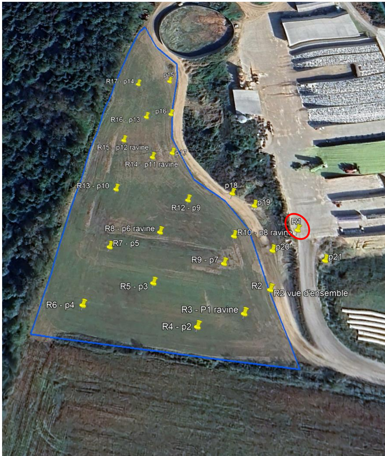
Figure 18 : Plan échantillonnage de sol
