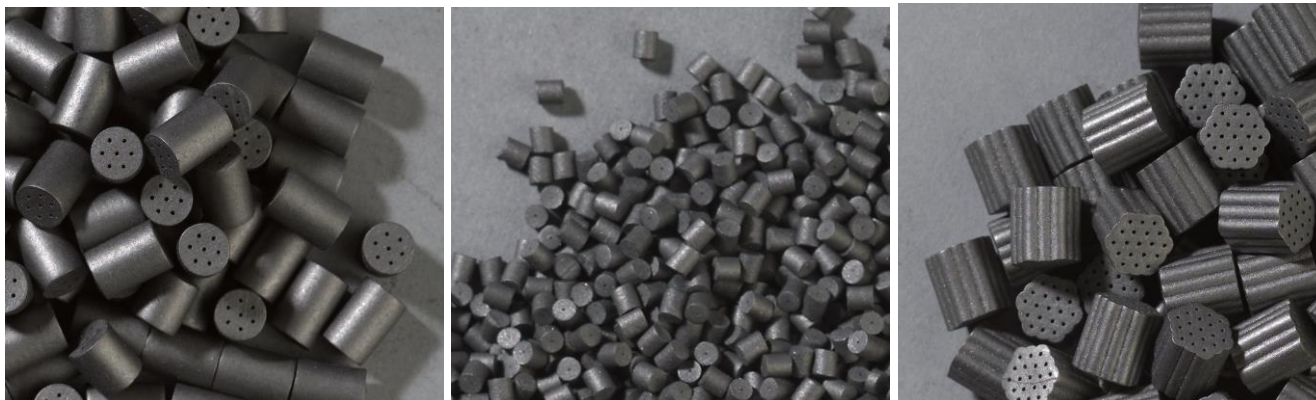
Figure 3 Exemple de granule de matériaux énergétiques produits au site de GD-OTS Valleyfield
