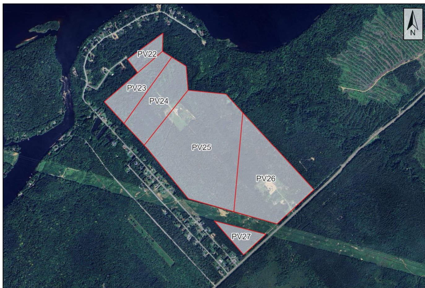
Figure 5-2 – Zones générales des panneaux photovoltaïques tracées dans le logiciel GlareGauge (site sud)
