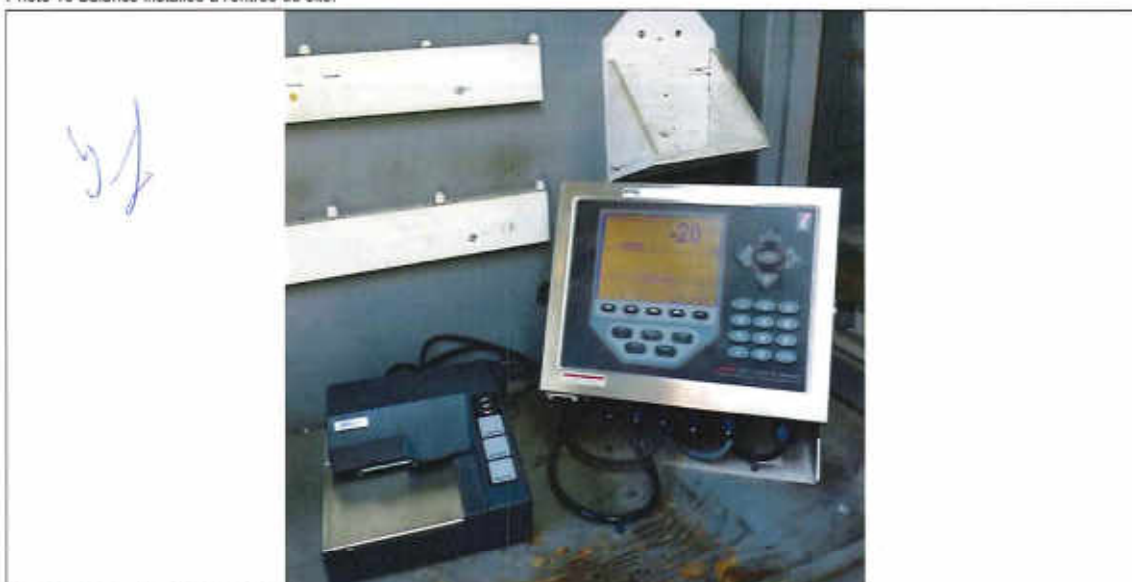
IMG_20190709_115839 (1024x1024).jpg Photo 11 Instrument servant à la pesée des camions.
