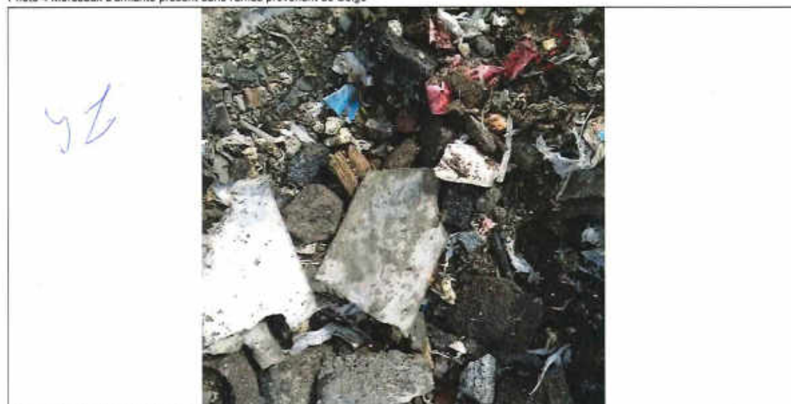
Photo 5 Morceau d'amiante en plaque.
