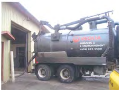
Photo 5 : 11-10-2007 Camion-vacuum utilisé pour le nettoyage de la dalle de béton et des puits de captation. Vue vers le nord.
