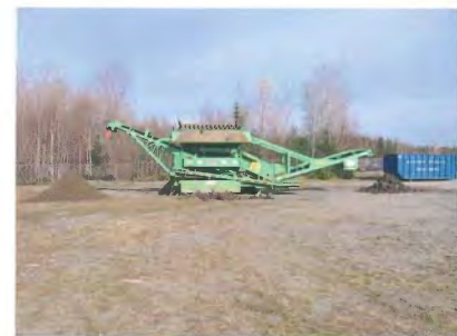
Photo 15 : 29-10-2007 Tamiseuse utilisée pour la ségrégation des débris rencontrés lors de l'excavation des sols dans le secteur nord-ouest du site. Vue vers le nord.
