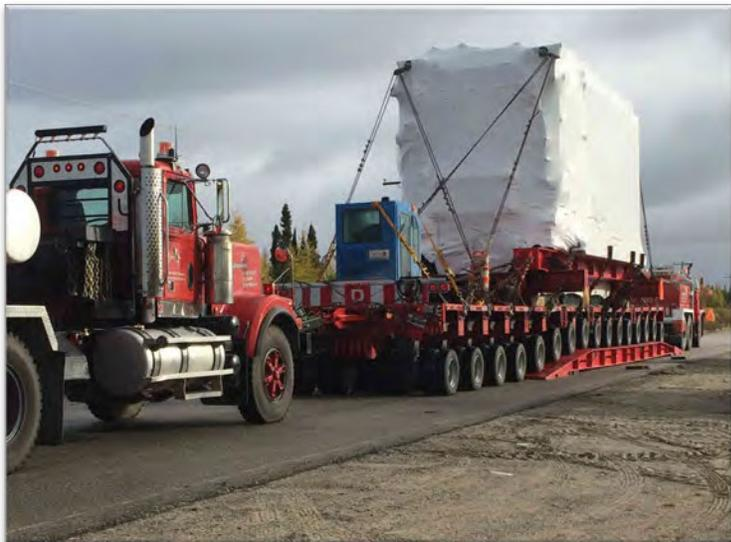
Des pontons de 15m ont été utilisés en 2015 sur la route de la Baie James lors du transport d'un transformateur de puissance destiné au poste Albanel. Le ponceau sous la route (que l'on ne voit pas sur la photo) ne possédait pas la capacité suffisante pour reprendre les charges que la masse de 325t totale en charge (soit 20t sur chaque essieux) représentait.
