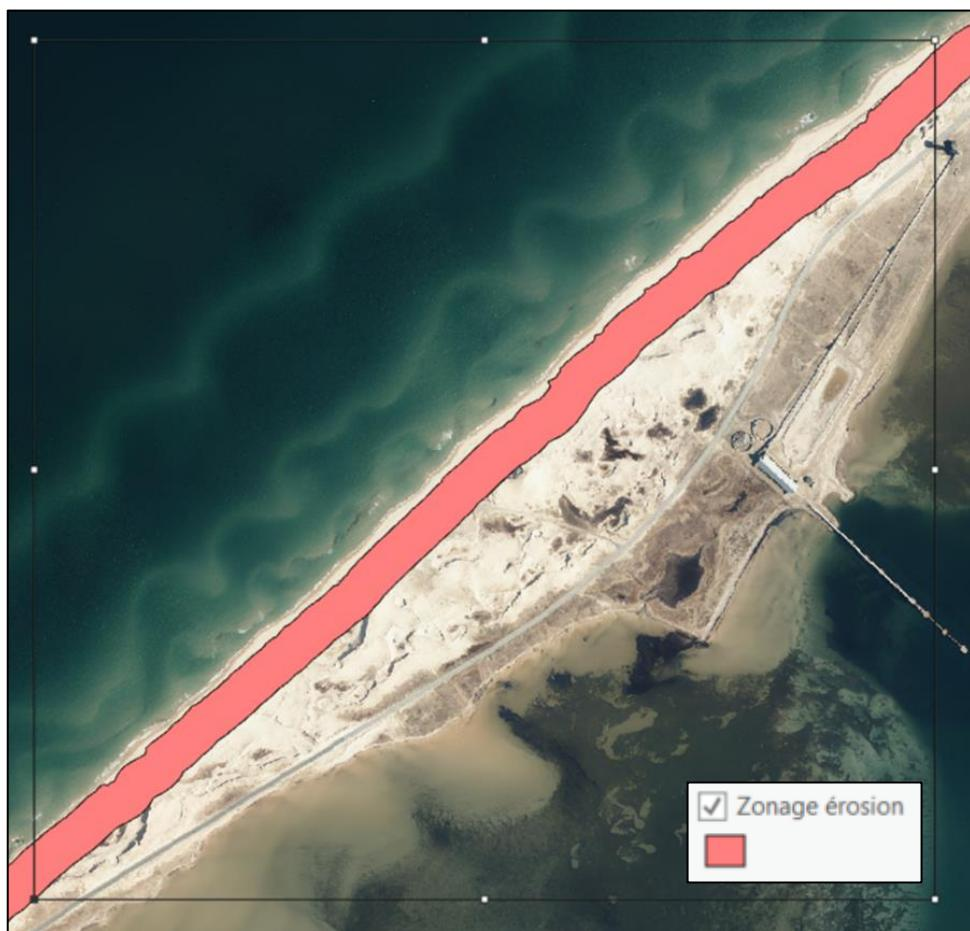
**Figure 3. Marge de sécurité proposée en érosion côtière (bande de 90 m à partir du trait de côte de 2008)**
