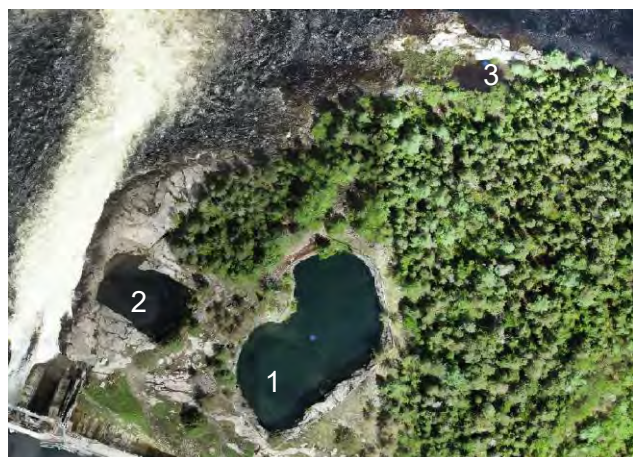
Photo 38. Aucune connectivité au niveau des bassins 1 et 2 à un débit de 178 m 3 /s
