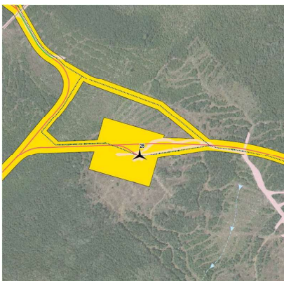
Figure 1 dédoublement réseau collecteur éolienne 25
