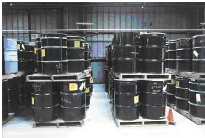
Figure 1 : Aménagement adéquat d'une aire d'entreposage en îlots
