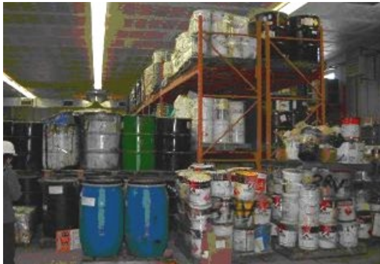
Figure 2 : Aménagement inadéquat, manque d'accessibilité des aires d'entreposage
