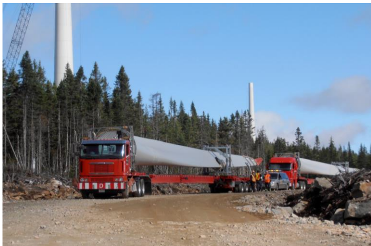
Figure 3.2 Camions de transport de pales d'éoliennes en milieu forestier
