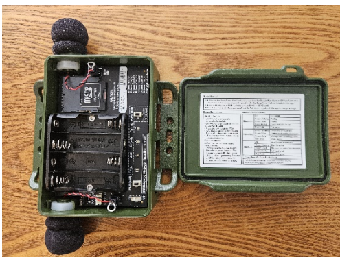
Photo 1. Enregistreur Song Meter Mini (Wildlife acoustics)
