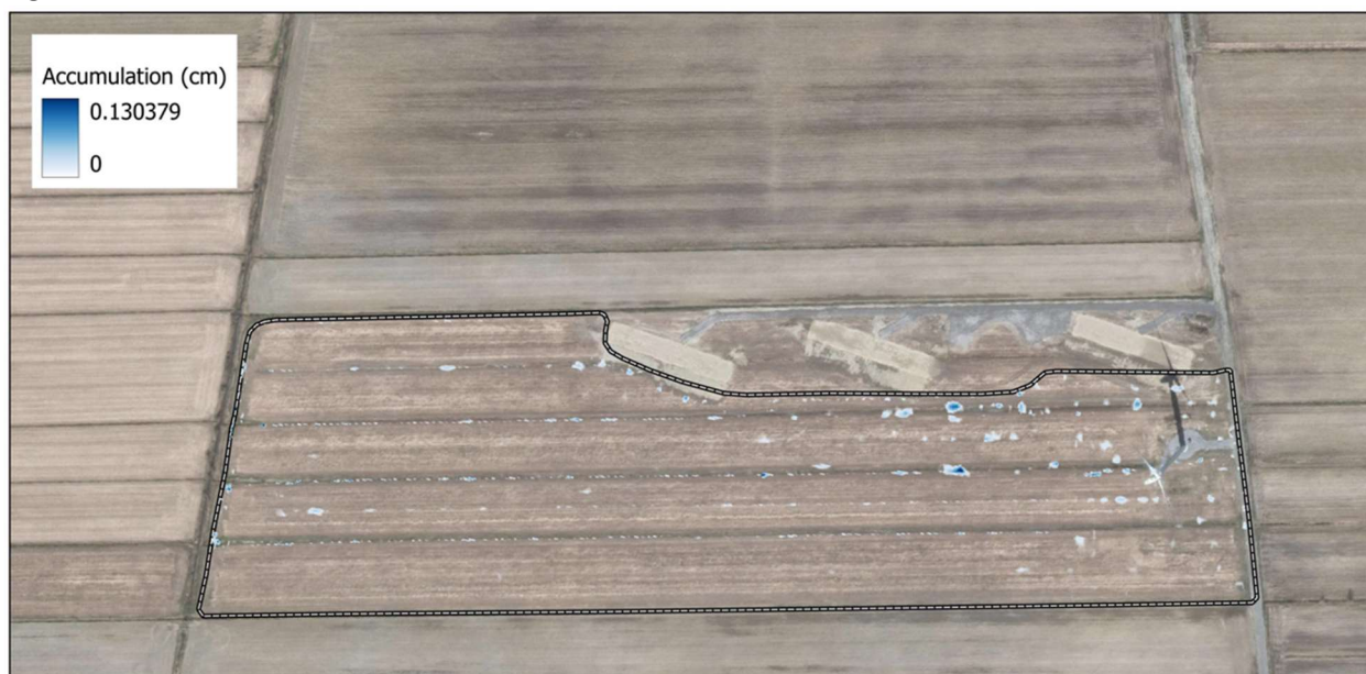
Figure 7 : zones d'accumulation d'eau autour de l'éolienne PS6
