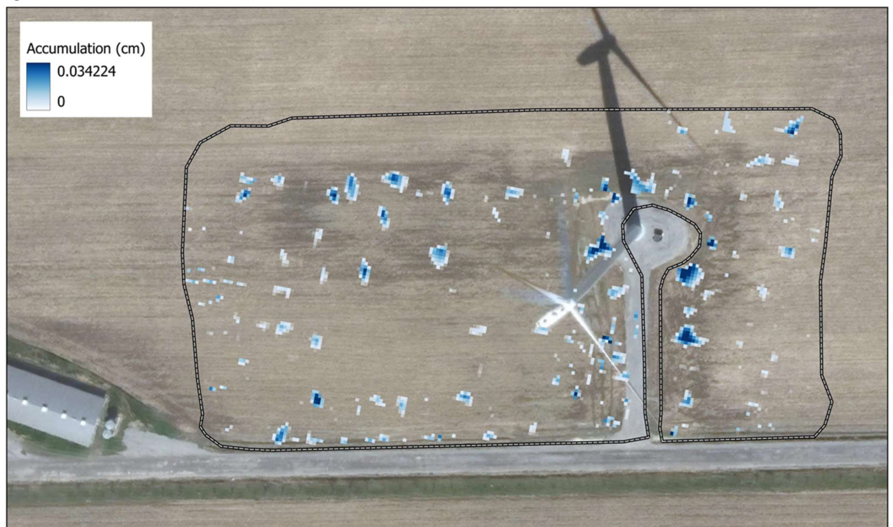
Figure 6 : Zones d'accumulation d'eau autour de l'éolienne PS6.
