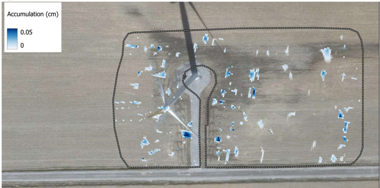
Figure 5 : Zones d'accumulation d'eau autour de l'éolienne PS5
