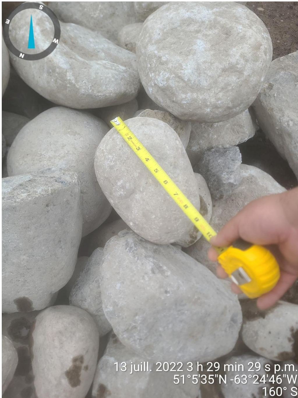
PHOTO 9 Till (13-07-2022): Amas de pierres, zone 3 au Nord-Est. Diamètre des pierres (200 à 400 mm) conforme
