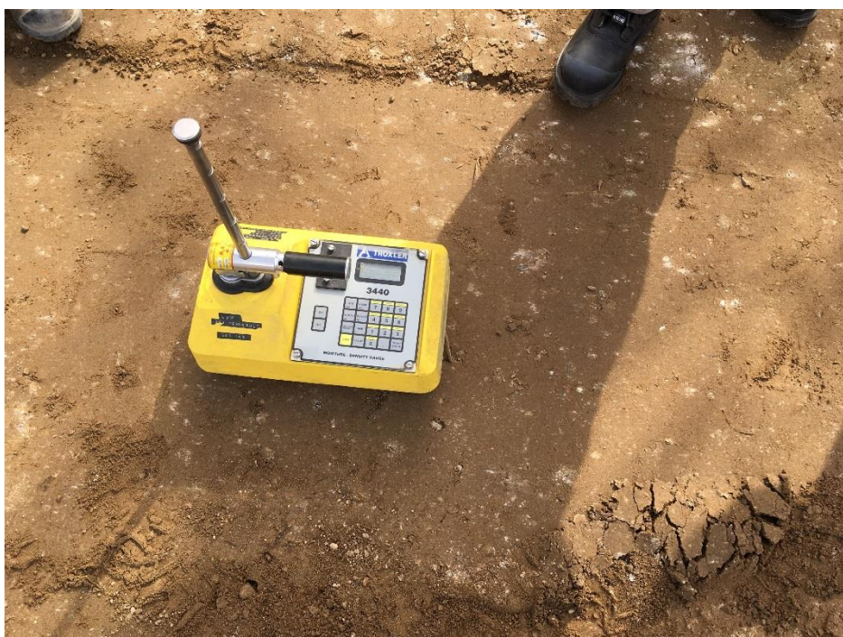
PHOTO 16 Masseku (19-09-2018) : Essai de compaction sur la zone de remblai pour connaître le nombre de passes au compacteur pour atteindre la compacité requise
