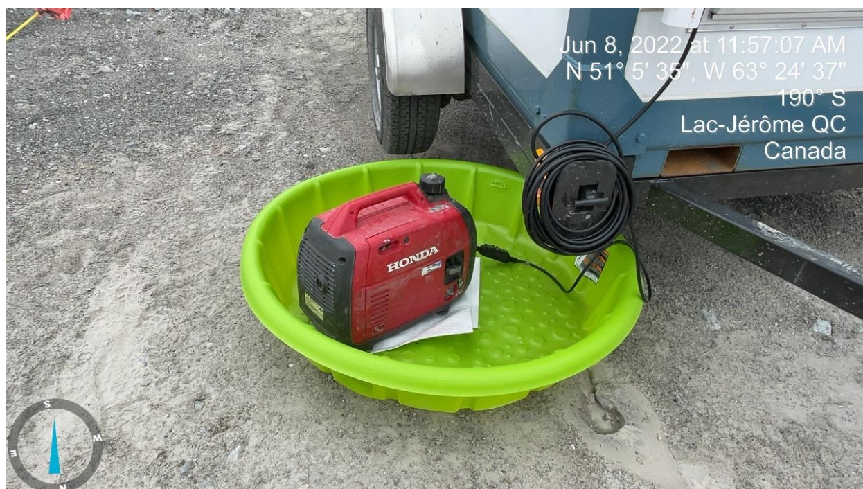
PHOTO 15 Till (08-06-2022) : Bassin de récupération sous une génératrice
