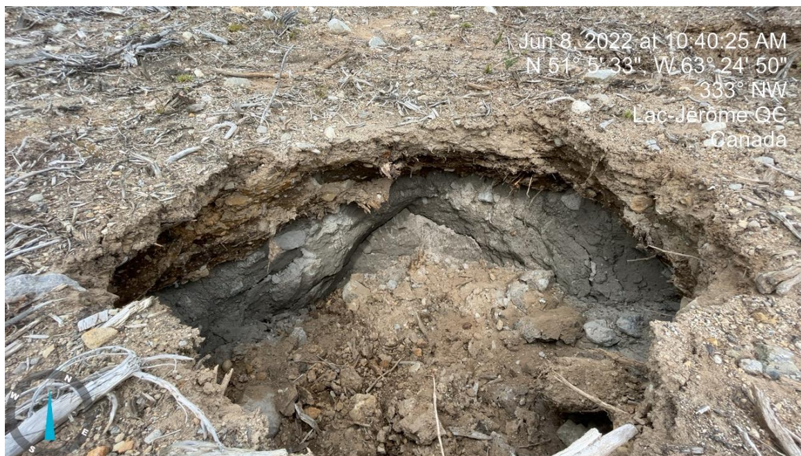
PHOTO 3 Till (08-06-2022) : Couche de 400mm de terre végétale dans le secteur ouest de la zone 4 (localisation photo 4)
