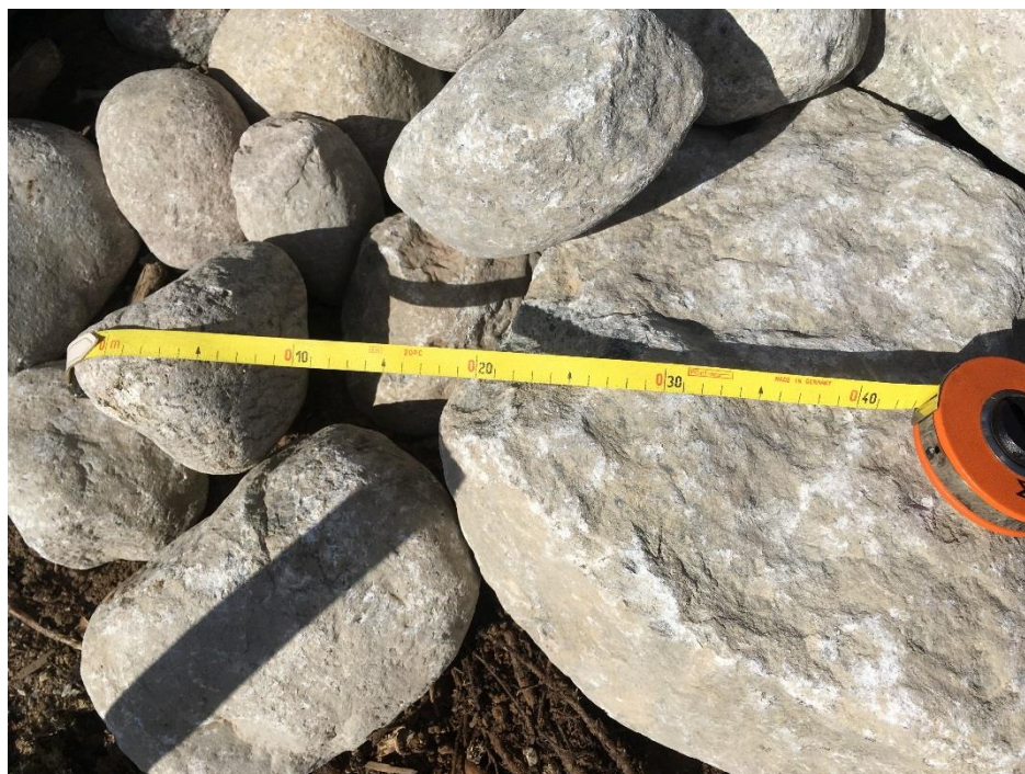
PHOTO 14 Mista (04-09-2018) : Pierres de diamètre variable de l'ordre de 200 à 400 mm pour l'aménagement des amas de pierres
