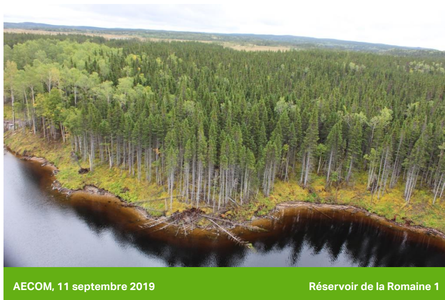
Photo 40 Nouveau talus susceptible d'érosion localisé sur la rive est du réservoir de la Romaine 1 (PK 60,2)
