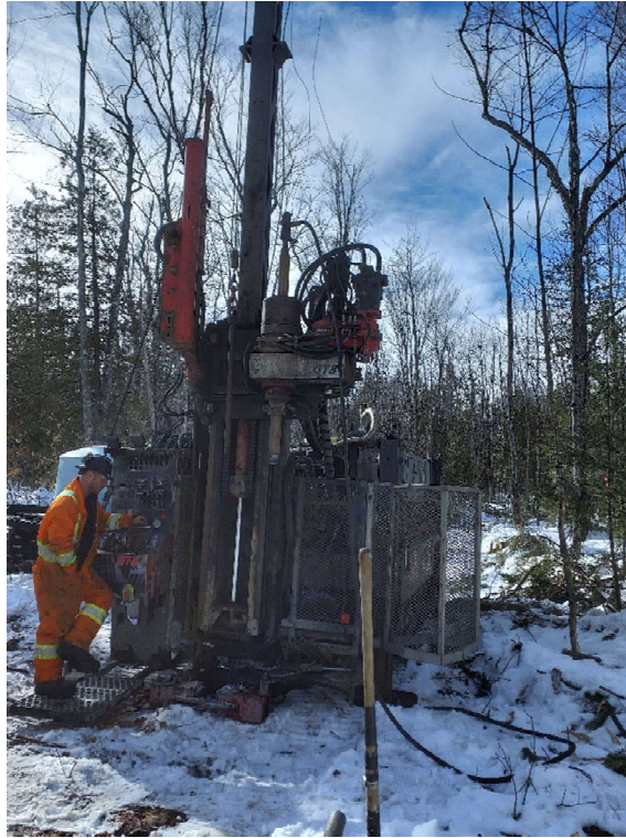
Photographie 1 : Foreuse à tarière montée sur une remorque sur chenille avec une tête de rotation GT8
