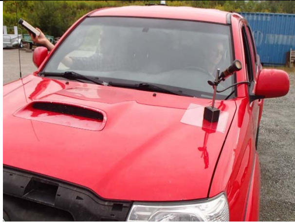
Photo 1 : Détecteurs d'ultrasons utilisés pour l'inventaire acoustique mobile des chiroptères
