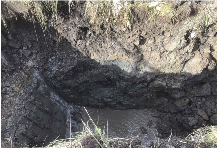
Photo 13 Vue montrant la forte infiltration d'eau à l'intérieur de la tranchée de reconnaissance 22E204-021
