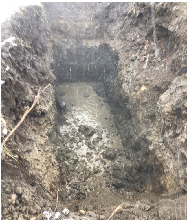
Photo 11 Vue montrant la forte infiltration d'eau à l'intérieur de la tranchée de reconnaissance 22E204-020
