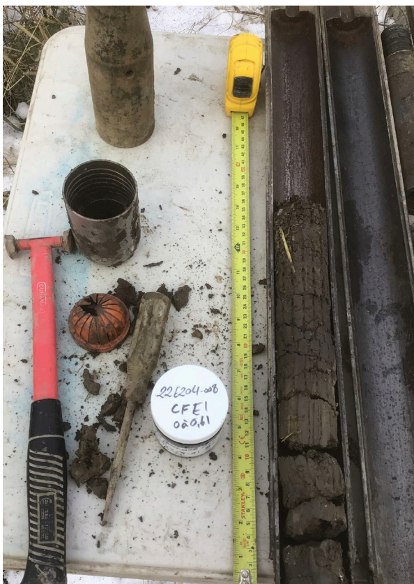
Photo 3 Vue montrant la cuillère fendue prélevée à l'endroit du forage 22E204-008 entre 0,00 et 0,61 m de profondeur
