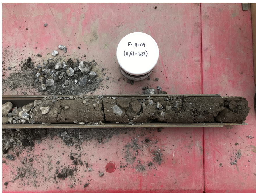
Photographie 5 Aperçu des sols en profondeur dans le forage PO-19-04.
