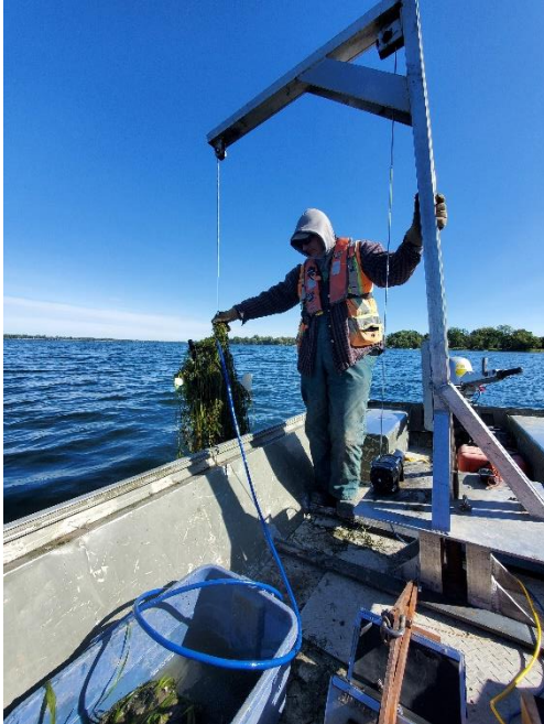
Photo 10 : Sortie de l'eau de la caméra sous-marine couverte de végétation aquatique
