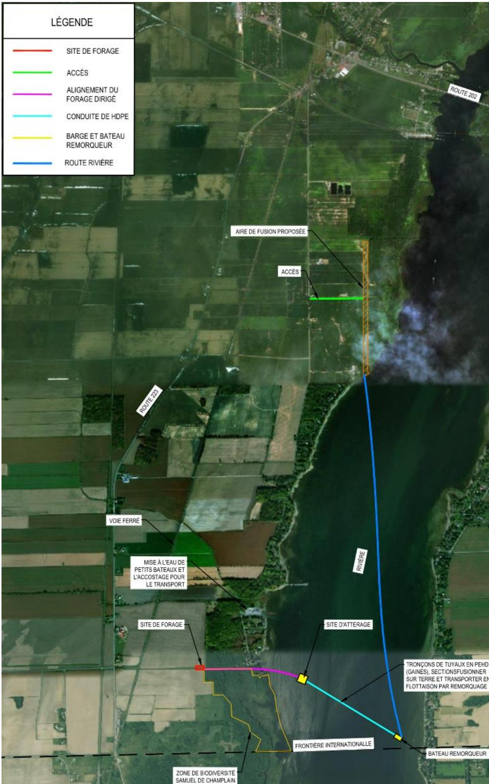
Figure 5.5 Concept de méthode de travail pour la fusion et l'installation des conduites en PEHD
